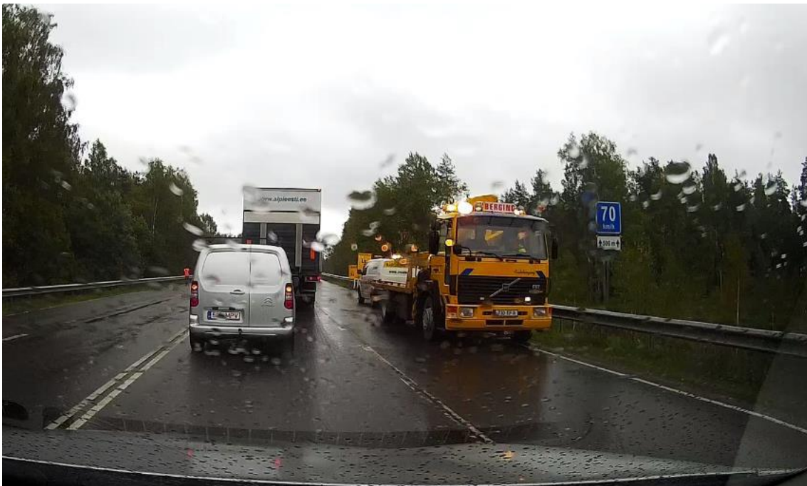
Joonis 2.4 Ehitussõidukid pargivad vastassuunas märkide ette. Raske rikkumine. [7]
