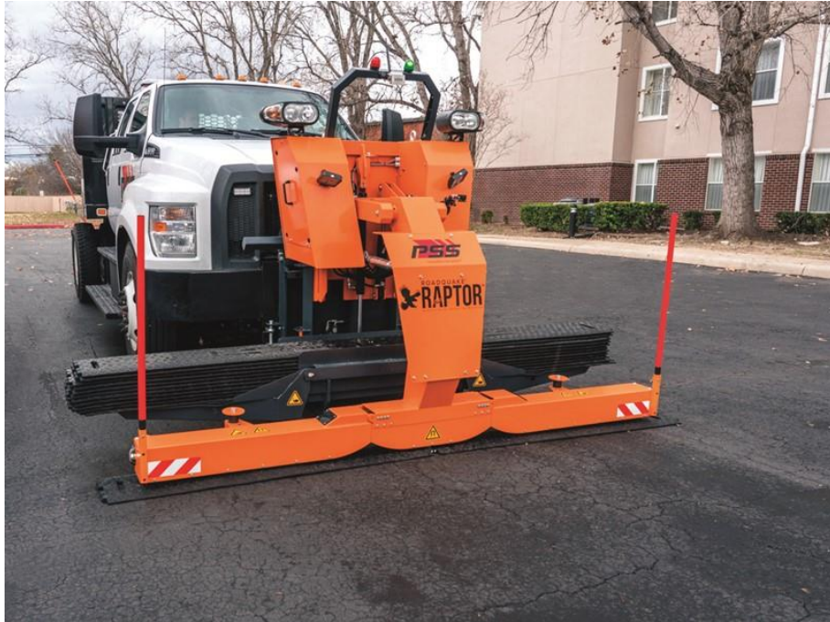
Joonis 3.13 Spetsiaalne täristide paigalduse seade „RoadQuake Raptor“™ [10]
