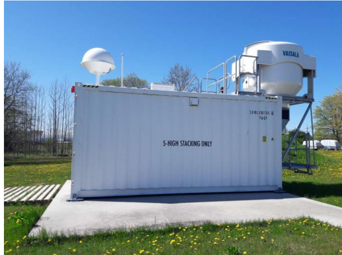
Joonis 10: Tallinn-Harku aeroloogiajaama automaatne raadiosondijaam (Ilmateenistus, 2020).
