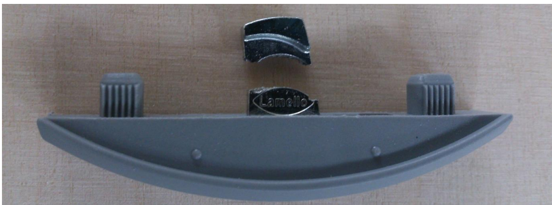
Joonis 30. Keelest purunenud Clamex P10.
