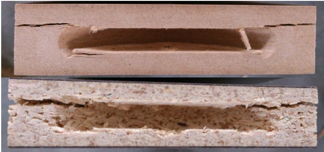
Joonis 31. MDF ja PLP katsekehad Clamex P15 kinnitusfurnituuriga.
