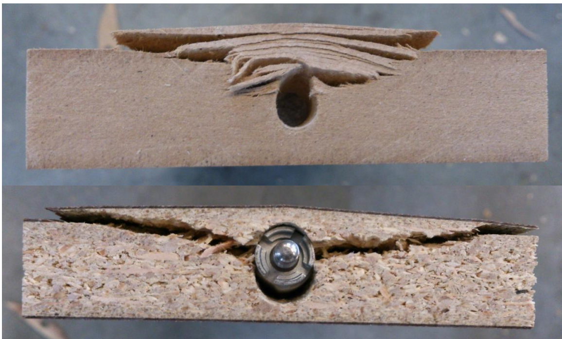
Joonis 32. Invis Mx kinnitusfurnituur MDF-is ja PLP-s nihkekatsekeha.
