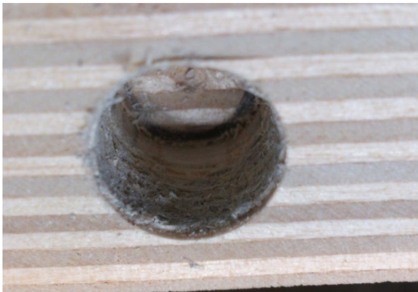
Joonis 28. Invis Mx ava muljutud sisepind.
