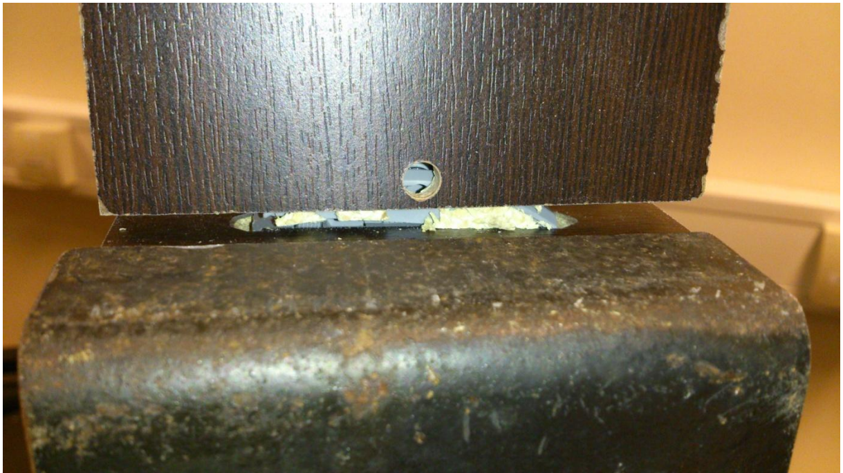
Joonis 27. Clamex P10 tõmbekatse.
