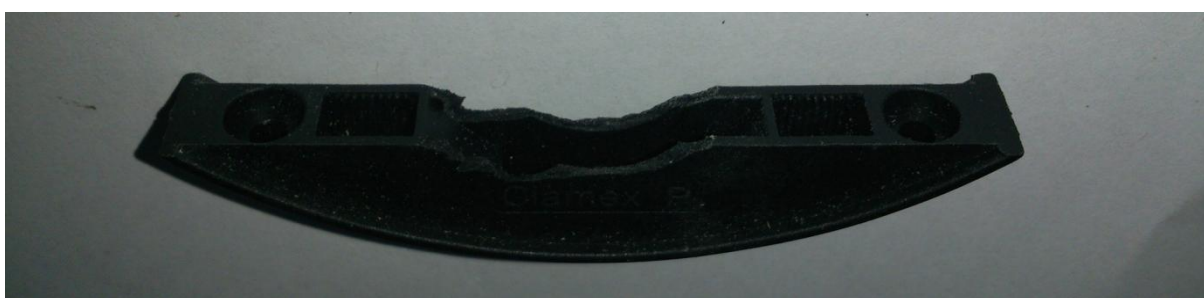
Joonis 26. Ankrust purunenud Clamex P15 katsekeha.
