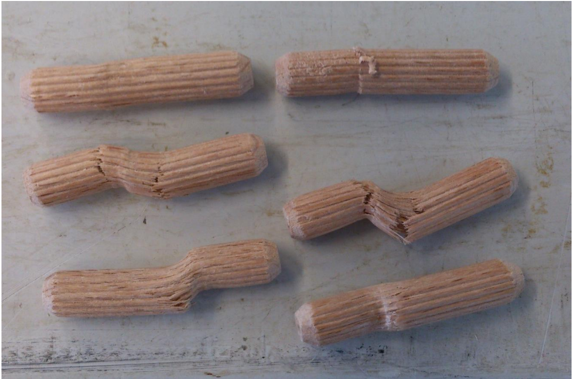
Joonis 33. Muljunud ja/või purunenud puittüüblid
