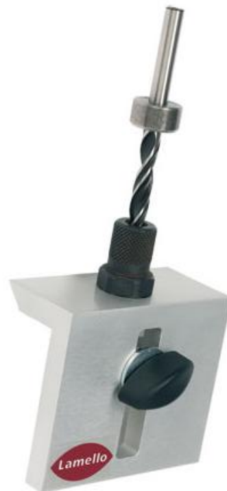
Joonis 19. Vasakul Invis MiniMag koos poldi otsikuga. Paremäl Clamex P puurimisrakis. (Lamello AG 2014)
