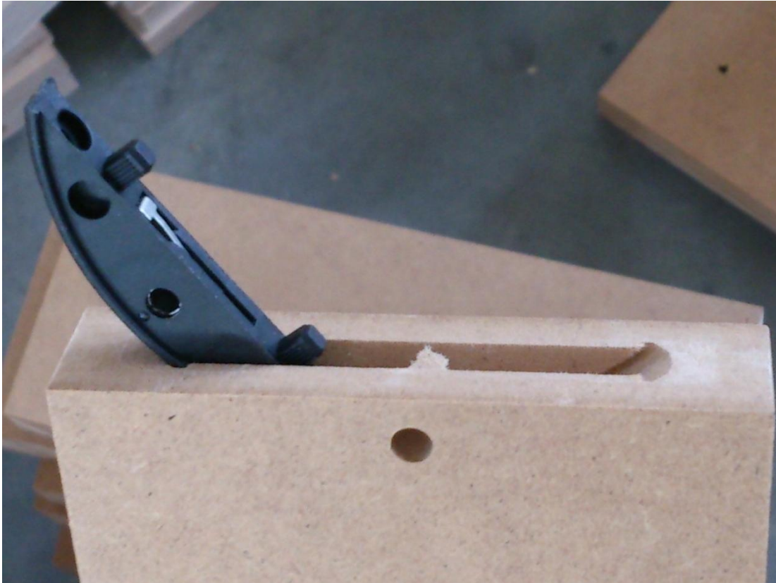
Joonis 8. Clamex P15 pesasse asetamine.
