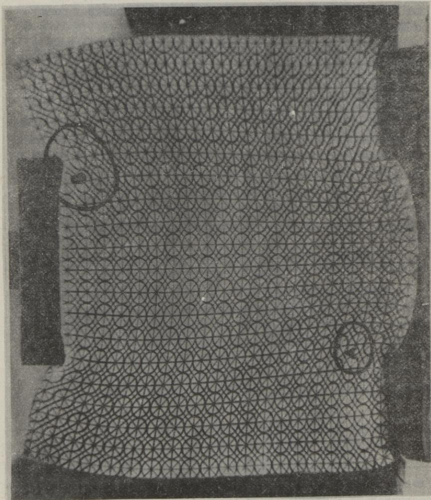
Фиг. 3. Поле перемещений при штамповом нагружении образца с нагрузкой 690 кг.
