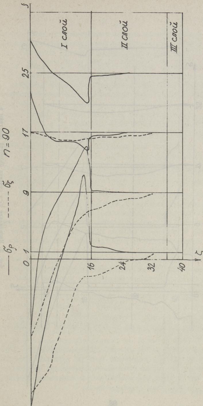
Фиг. 4. Напряжения  $\sigma_r$  и  $\sigma_z$  в сечении слоистой пластины в момент времени  $\tau = 90$ .
