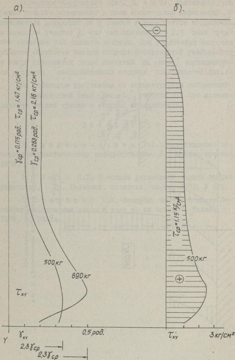
Фиг. 4. Распределение касательных напряжений в плоскости среза при штамповом нагружении образца:
