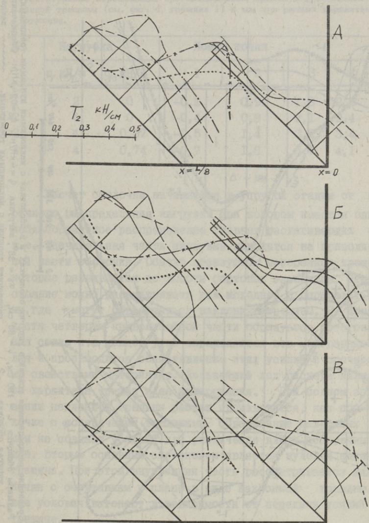
Фиг. 7. Распределение главных сил  $T_2$  у искусственной трещины. Обозначения и нагрузки см. на фиг. 6.
