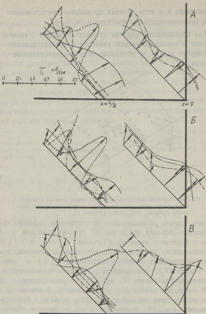
Фиг. 6. Распределение главных сил  $\bar{T}_1$  у искусственной трещины при нагрузках
