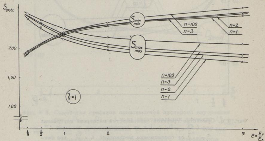
Фиг. 5 б. Зависимость экстремальных значений внутренних сил  $S_{extr}$  от перепада толщины балки-стенки ( $n$ ) для асимметричной нагрузки.
