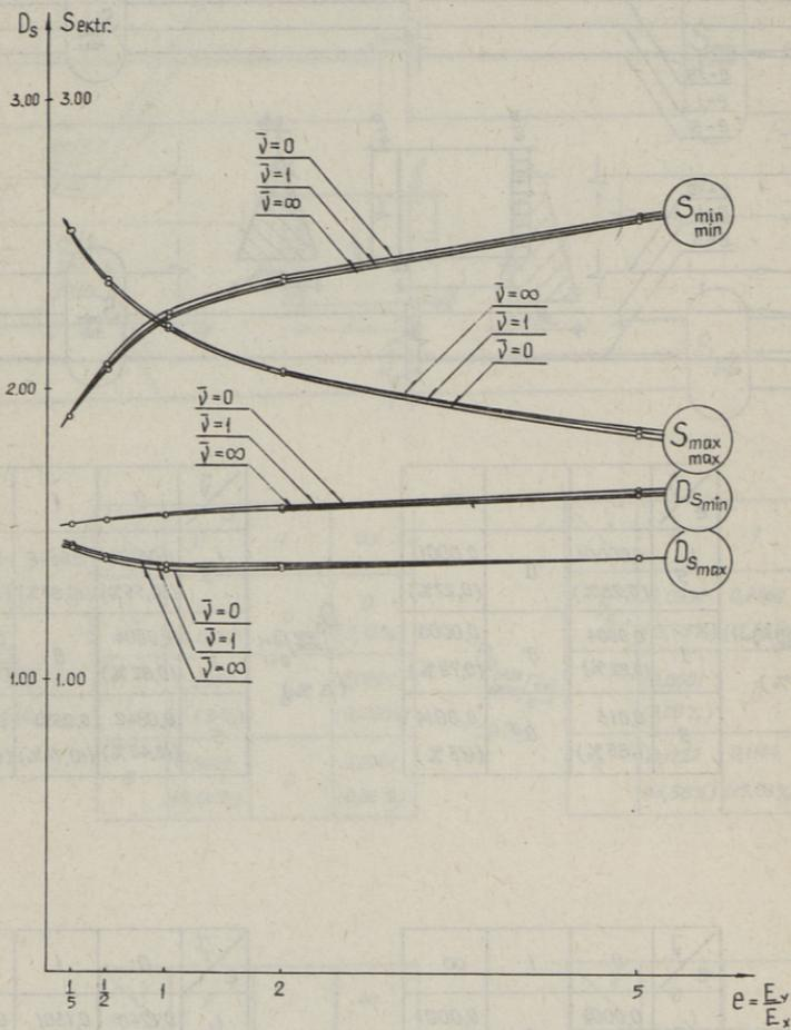
Фиг. 3 а. Семейство графиков зависимостей дисперсий внутренних сил ( $D_{S_{\max}}, D_{S_{\min}}$ ) и их экстремальных значений ( $S_{\max}, S_{\min}$ ) от соотношения жесткостей  $e = \frac{E_y}{E_x}$  при фиксированных значениях безразмерного коэффициента Пуассона  $\bar{\nu} = \frac{\nu_y}{\nu_x} = 0, 1, \infty$  в балке-стенке с перепадом толщины  $n = \frac{h_1}{h_0} = 2$  для симметричной нагрузки.
