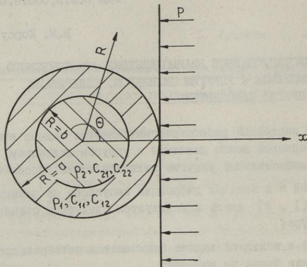
Фиг. 1. Сечение оболочки в момент соприкосновения с фронтом плоского импульса давления.
