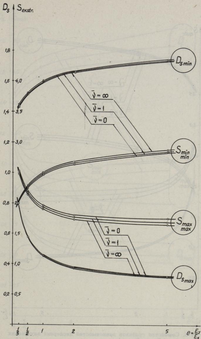
Фиг. 4 а. Семейство графиков зависимостей дисперсий внутренних сил ( $D_{S_{max}}, D_{S_{min}}$ ) и их экстремальных значений ( $S_{max}, S_{min}$ ) от соотношения жесткостей  $e = \frac{E_y}{E_x}$  при фиксированных значениях безразмерного коэффициента Пуассона  $\bar{\nu} = \frac{\nu_y}{\nu_x} = 0, 1, \infty$  в балке-стенке с перепадом толщины  $n = \frac{h_1}{h_0} = 2$  для асимметричной нагрузки.
