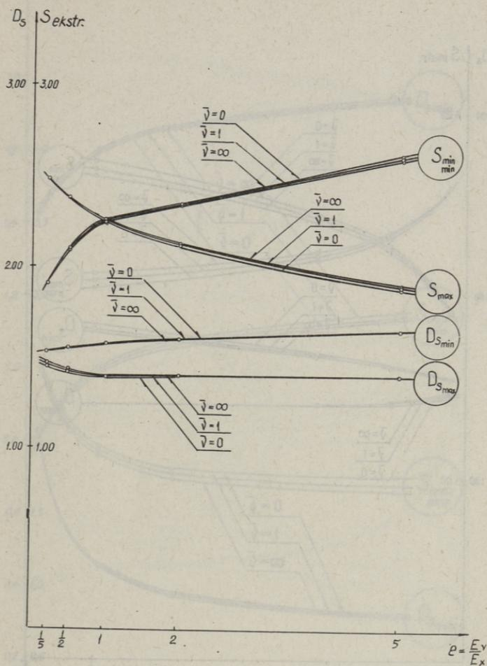
Фиг. 3 б. Семейство графиков зависимостей дисперсий внутренних сил ( $D_{S_{\max}}, D_{S_{\min}}$ ) и их экстремальных значений ( $S_{\max}, S_{\min}$ ) от соотношения жесткостей  $\rho = \frac{E_y}{E_x}$  при фиксированных значениях безразмерного коэффициента Пуассона  $\bar{\nu} = \frac{\nu_y}{\nu_x} = 0, 1, \infty$  в балке-стенке с перепадом толщины  $n = \frac{h_1}{h_0} = 3$  для симметричной нагрузки.
