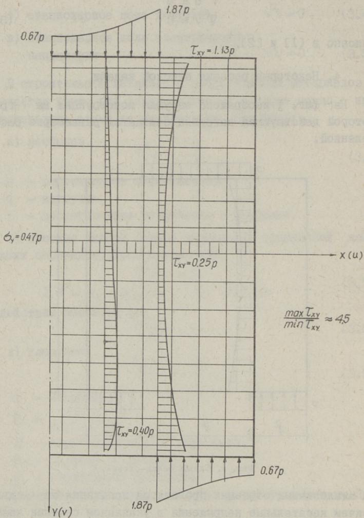
Фиг. 2. Эпюры напряжений при жесткой опоре.
