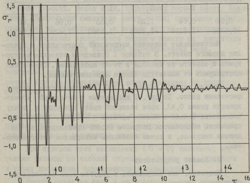
Фиг. 2. Зависимость радиального напряжения  $\sigma_r$  от времени в фиксированной точке  $\tau = 0,9$ ,  $\Theta = 0$ .
