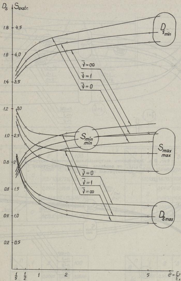
Фиг. 4 в. Семейство графиков зависимостей дисперсий внутренних сил ( $D_{s_{\text{max}}}$ ,  $D_{s_{\text{min}}}$ ) и их экстремальных значений ( $S_{\text{max}}$ ,  $S_{\text{min}}$ ) от соотношения жесткостей  $e = \frac{E_y}{E_x}$  при фиксированных значениях безразмерного коэффициента Пуассона  $\bar{\nu} = \frac{\nu_y}{\nu_x} = 0, 1, \infty$  в балке-стенке с перепадом толщины  $n = \frac{h_1}{h_0} = 100$  для асимметричной нагрузки.
