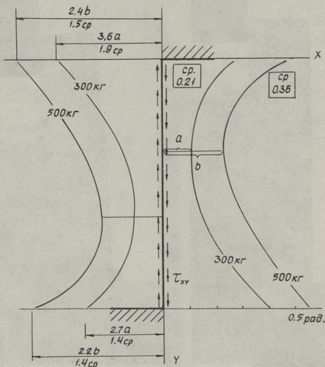
Фиг. 2. Эпюры угла сдвига  $\gamma_{xy}$  в плоскости среза.
