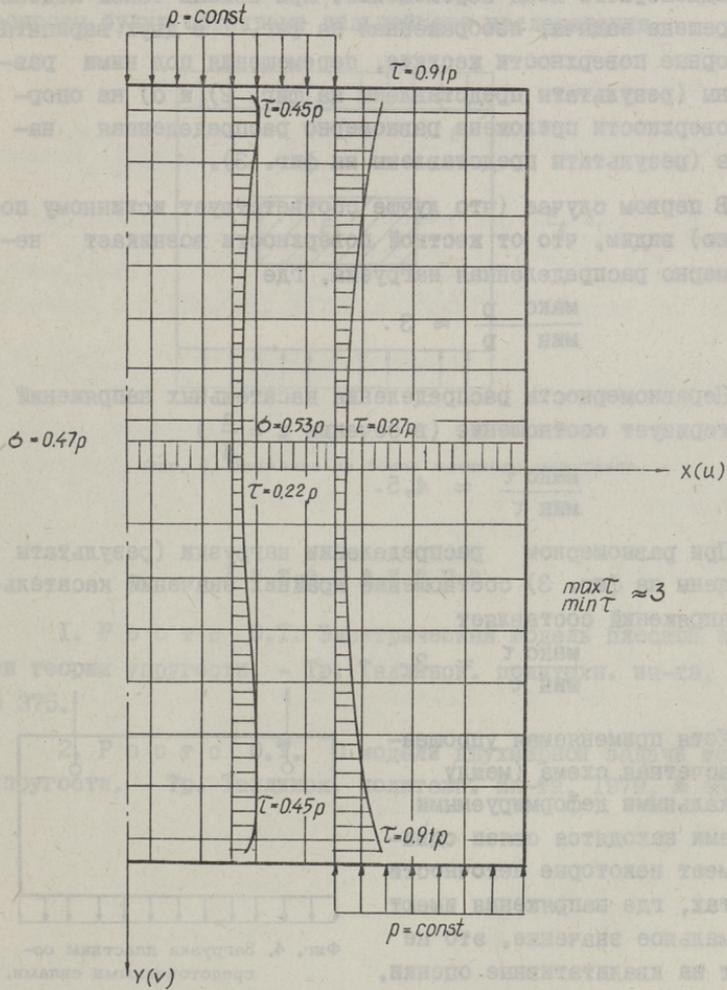
Фиг. 3. Эпюры напряжений при равномерно распределенной нагрузке.
