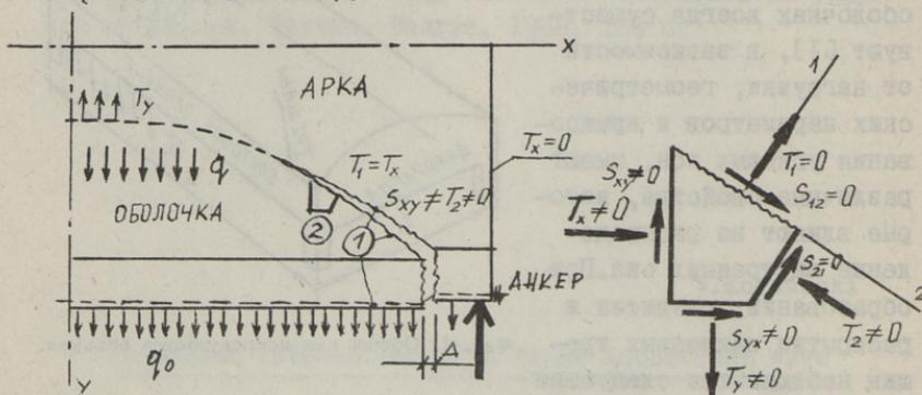
Фиг. 2. Схема трещин и внутренних сил в угловой зоне с наклонными трещинами
