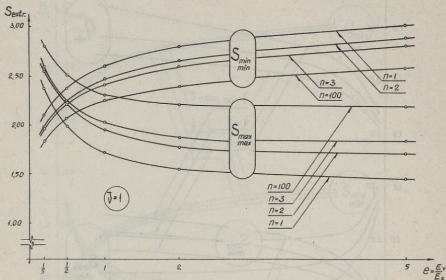
Фиг. 5 а. Зависимость экстремальных значений внутренних сил  $S_{extr}$  от перепада толщины балки-стенки ( $n$ ) для симметричной нагрузки.
