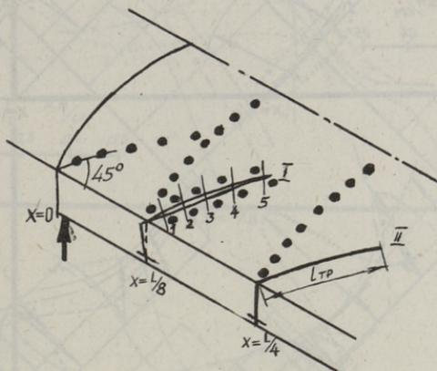
Фиг. 5. Расположение искусственных наклонных трещин и тензорезисторов, изменение геометрии оболочки в разных сторонах трещины (см. также таблица 2).
