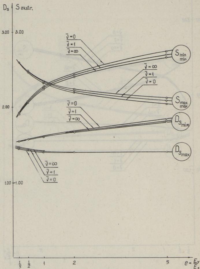
Фиг. 3 в. Семейство графиков зависимостей дисперсий внутренних сил ( $D_{s_{max}}$ ,  $D_{s_{min}}$ ) и их экстремальных значений ( $S_{max}^{max}$ ,  $S_{min}^{min}$ ) от соотношения жесткостей  $e = \frac{E_y}{E_x}$  при фиксированных значениях безразмерного коэффициента Пуассона  $\bar{\nu} = \frac{\nu_y}{\nu_x} = 0, 1, \infty$  в балке-стенке с перепадом толщины  $n = \frac{h_1}{h_0} = 100$  для симметричной нагрузки.
