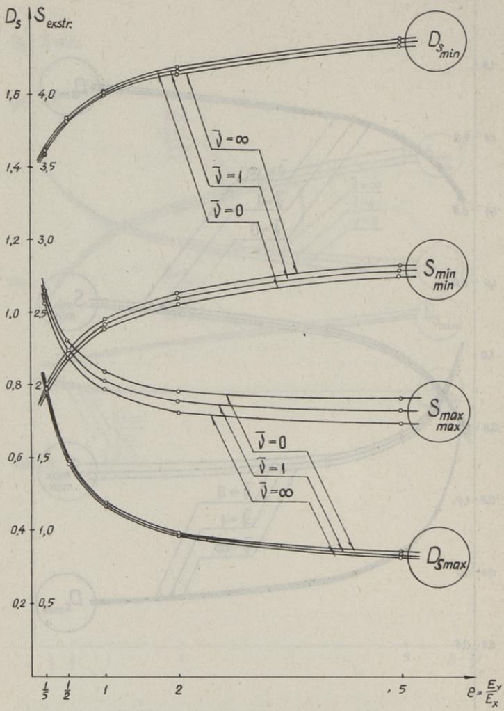
Фиг. 4 б. Семейство графиков зависимостей дисперсий внутренних сил ( $D_{S_{max}}, D_{S_{min}}$ ) и их экстремальных значений ( $S_{max}^{max}, S_{min}^{min}$ ) от соотношения жесткостей  $e = \frac{E_y}{E_x}$  при фиксированных значениях безразмерного коэффициента Пуассона  $\nu = \frac{\nu_y}{\nu_x} = 0,1, \infty$  в балке-стенке с перепадом толщины  $n = \frac{h_1}{h_0} = 3$  для асимметричной нагрузки.
