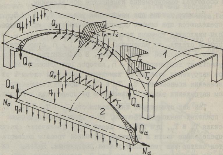
Фиг. 3. Расчетная схема оболочки с нулевыми наклонными трещинами. 1 - верхняя часть, работает как арка, 2 - нижняя часть, работает как оболочка или плита.
