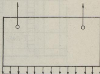
Фиг. 4. Загрузка пластины сосредоточенными силами.
