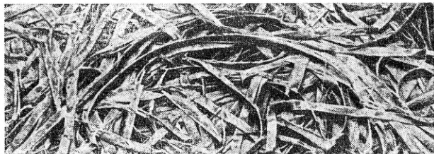
Joon. 1. TEP-plaadi pind on hall, kare, kuid tasane.
