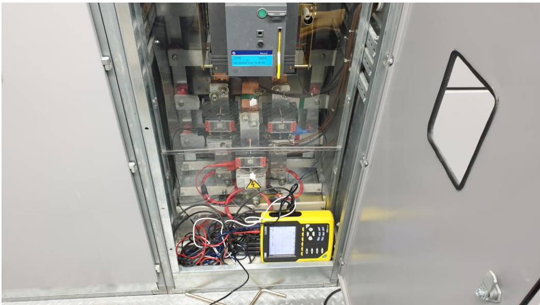
Joonis 11. Mõõtur 0,4 kV jaotla II sektsiooni sisendil
