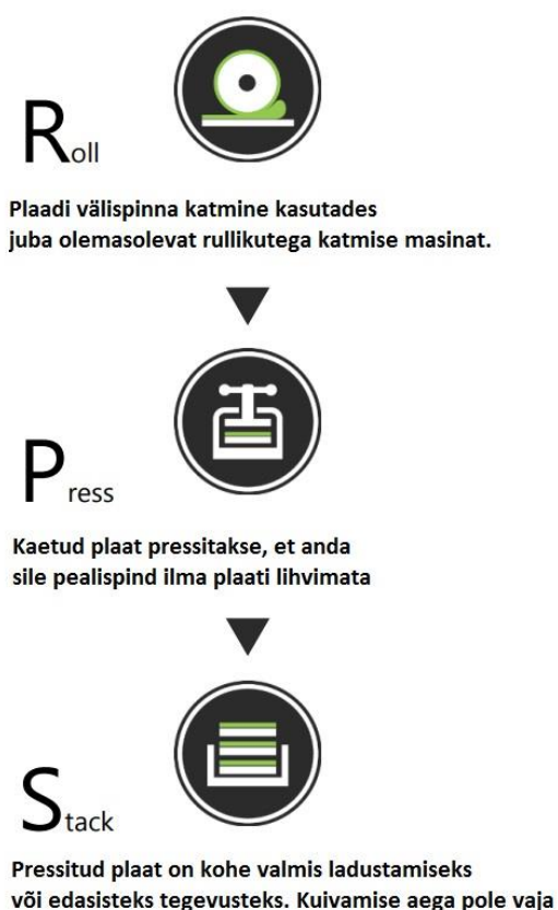
Joonis 7 Trollon tehnoloogia etapid
