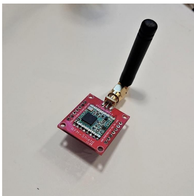
Joonis 5. Adapter-trükkplaadile joodetud LoRa moodul
