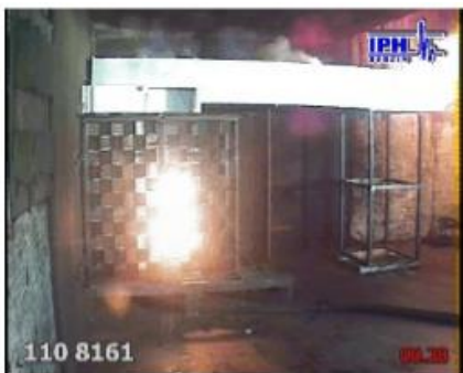
Joonis 1.18 Rõhulangetustoru kanali kasutamine elektrikaare ajal
