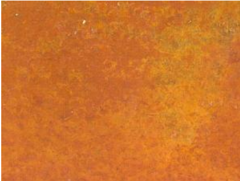
Joonis 2. Keemiliselt töödeldud pind (Patineeritud pind)
