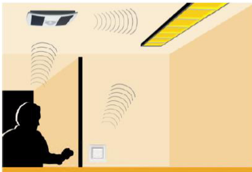
Joonis 2.32. EnOceani juhtimissüsteemil töötav valgustussüsteem
