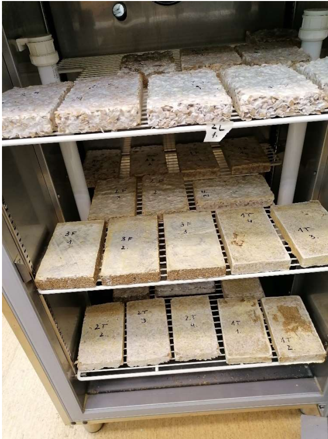
Joonis 18. Niiskuskatse katsekehad peale 48h. Autori foto
