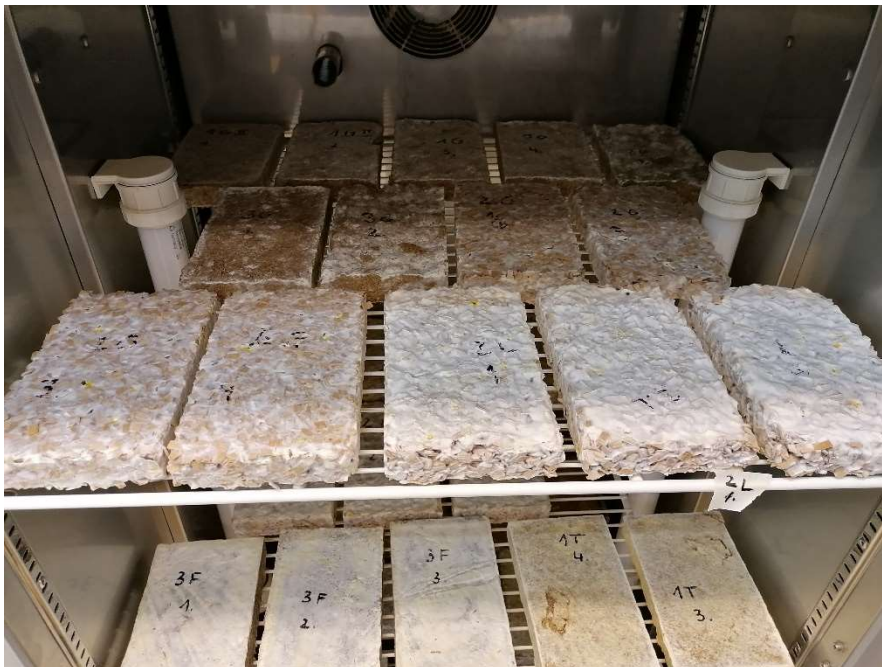
Joonis 12. Katsekehad kliimakambris, katse algus. Autori foto
