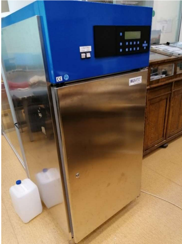
Joonis 11. Kliimakamber RUMED 3401. Autori foto
