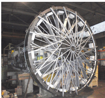
8.12.2009. Goliath'i suure (250 kVA) ja väikese (5 kVA) rõngasgeneraatori katsed Voltas.
