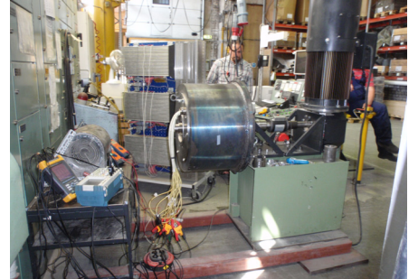
27.06.2011. Viktor Kesküla ja Ants Kallaste katsetamas AM-instituudi teadlaste projekteeritud PM-tuulegeneraatorit võimsusega 20 kVA. Konesko PM tuulegeneraator masti otsas ning generaatori katsestend ja abiseadmed Koneskos.
