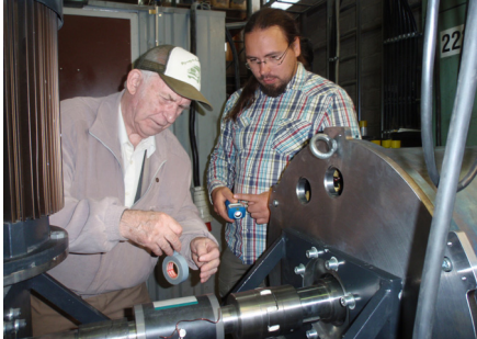
27.06.2011. Viktor Kesküla ja Ants Kallaste katsetamas AM-instituudi teadlaste projekteeritud PM-tuulegeneraatorit võimsusega 20 kVA. Konesko PM tuulegeneraator masti otsas ning generaatori katsestend ja abiseadmed Koneskos.
