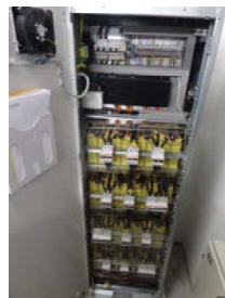
Mikrovõrgu katsestand elektrienergia kiirsalvestamiseks jaotusvõrgust elektriauto akupatareisse ja vastupidi Pildil Tõnu Lehtla, Hardi Hõimoja ja Elmo Pettai
