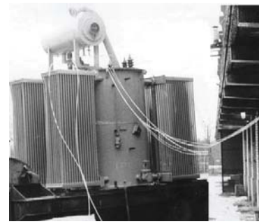
Turbas valminud 35 kV 3,3 Mvar juhitava reaktori katsed Ellamaa alajaamas
