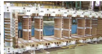
Ühe- ja kolmefaasilise juhitava reaktori magnetahel
