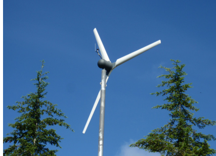
27.06.2011. Viktor Kesküla ja Ants Kallaste katsetamas AM-instituudi teadlaste projekteeritud PM-tuulegeneraatorit võimsusega 20 kVA. Konesko PM tuulegeneraator masti otsas ning generaatori katsestend ja abiseadmed Koneskos.
