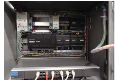
Mikrovõrgu katsestand elektrienergia kiirsalvestamiseks jaotusvõrgust elektriauto akupatareisse ja vastupidi Pildil Tõnu Lehtla, Hardi Hõimoja ja Elmo Pettai
