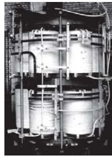
Turbas valminud 35 kV 3,3 Mvar juhitava reaktori katsed Ellamaa alajaamas
