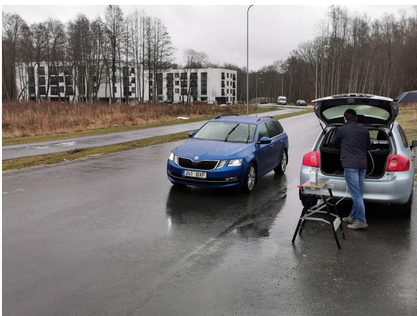
Joonis 4.4 Mõõdasõit alusele paigaldatud mikrofoni sensorist, autor
