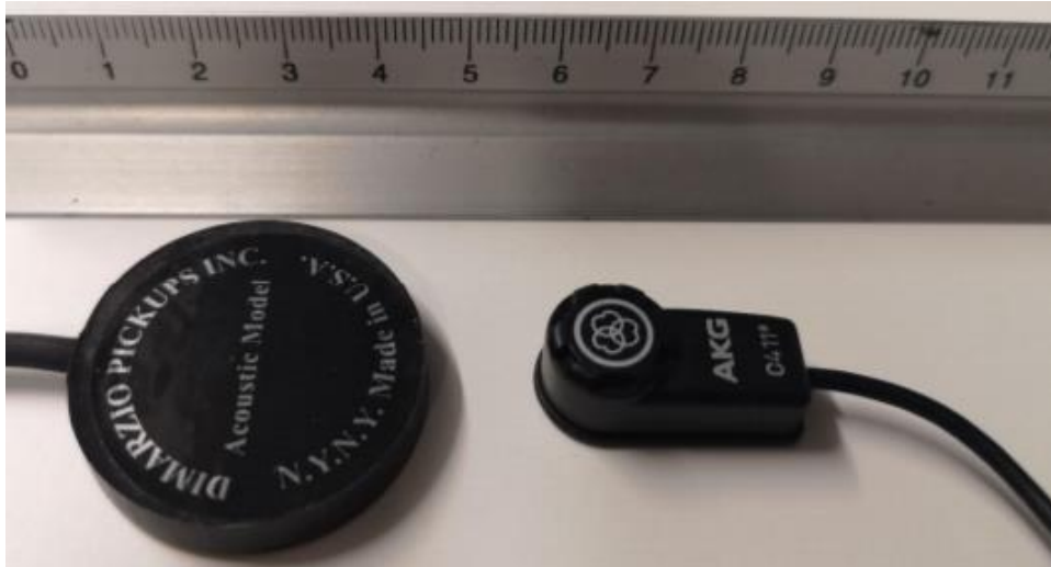
Joonis 7.2. Uuringus kasutatud kontaktmikrofonid. Vasakul DiMarzio DP130BK, paremal AKG C411 [35]
