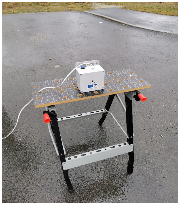
Joonis 4.3 Müramõõtmiseks kasutatud seade, autor.
