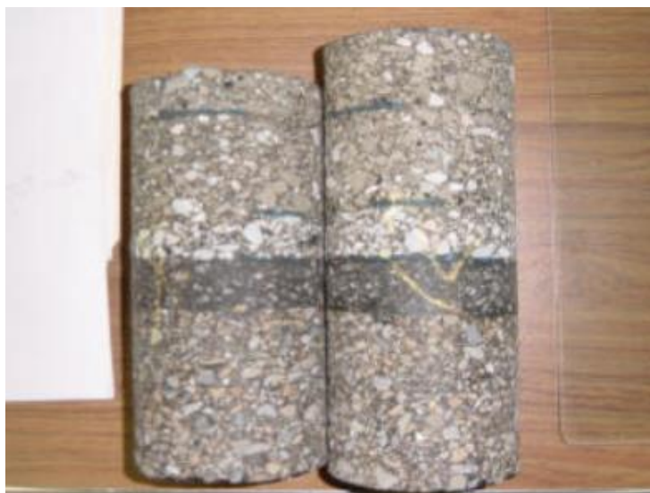
Joonis 1.2 Proovide võtmine teekatte kulumise mõõtmiseks [2]
