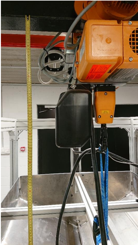
Joonis 8. Telfri tõstekonks ülemises asendis
