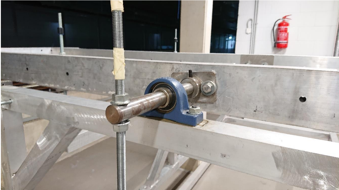
Joonis 5. Kasutuses olev pukklaager ja keermelatt M10. Kinnitusplaat viltu.
