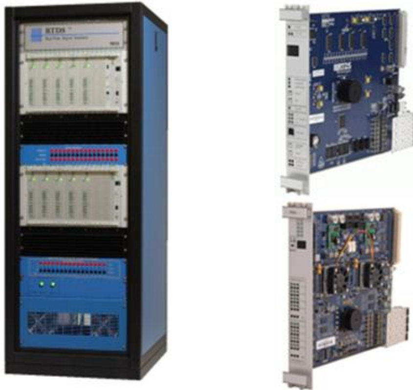
Joonis 3.4. RTDS (vasakul), GTWIF kaart (paremal üleval) ja protsessorkaart (paremal all)
