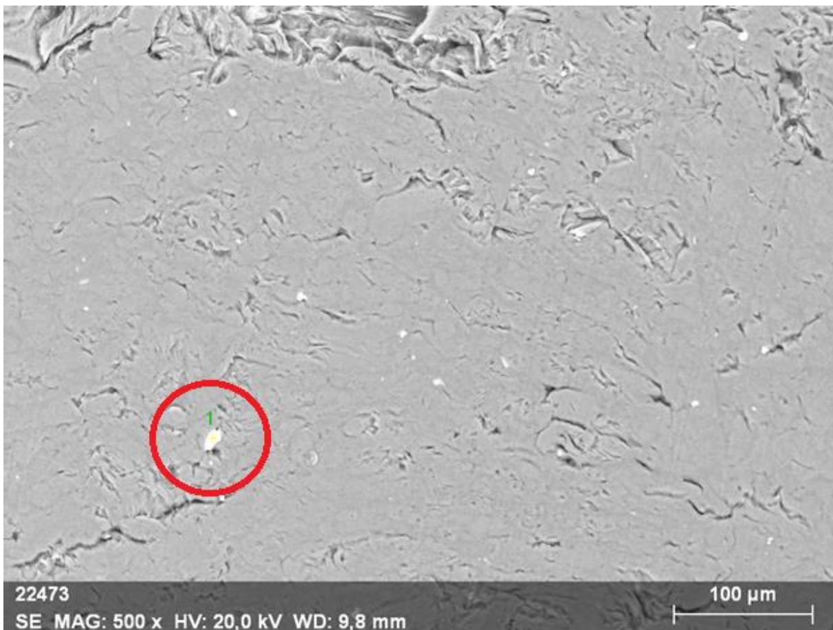
Joonis 4.5. SEM pilt. Messingu osake on valge osa punases ringis.
