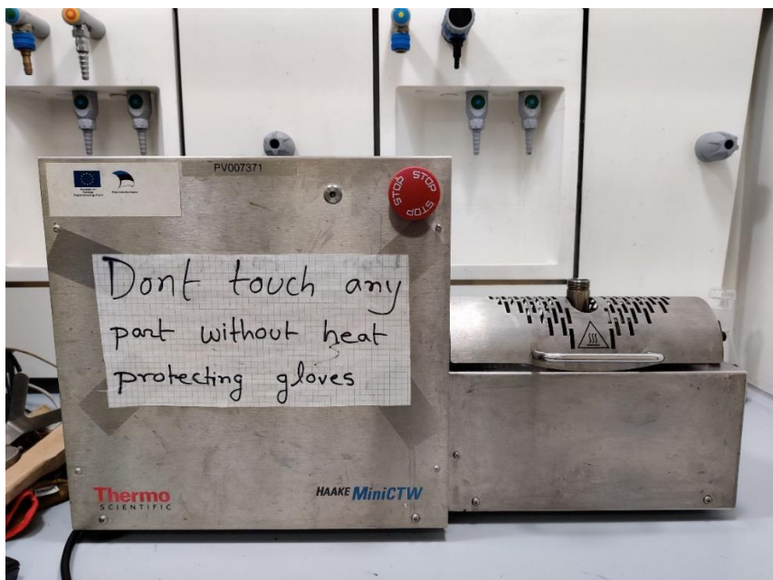
Joonis 3.1. Kasutatav kompauder Haake MiniCTW.
