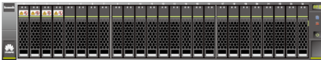
Joonis 5. Huawei OceanStor 2200V3 SFF eest vaade.
