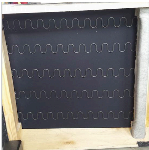
Joonis 6. AS Neiser Grupp diivani Inspira karkassis kasutatud sinusoidsed vedrud.
