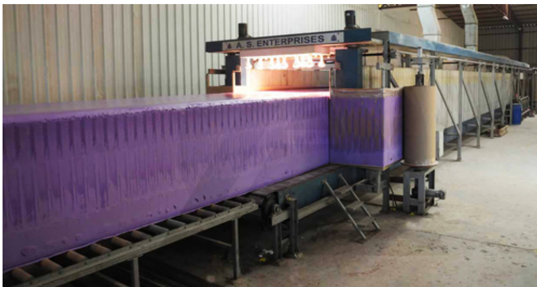
Joonis 2. Polüuretaanvahu valmistamine rea tüüpi masinaga [27].
