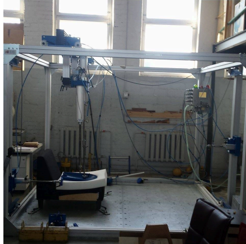
Joonis 9. Mehaaniline mööblikatsestend firmalt Hegewald & Peschke.
