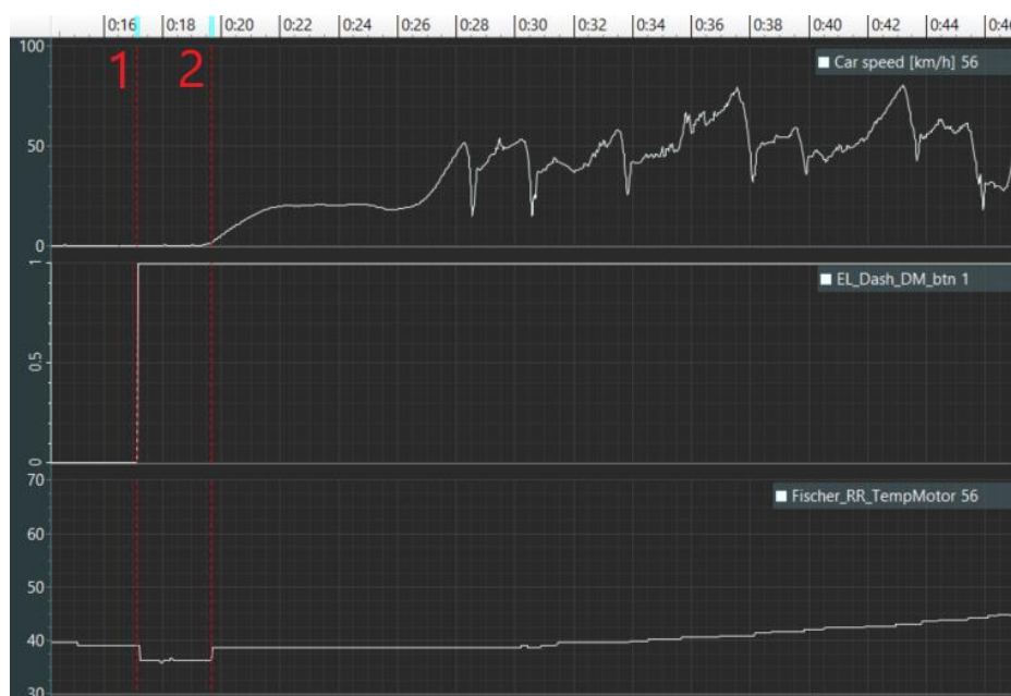
Joonis 23. Ekraanipilt CAN logist. Graafikul on näha ülevalt alla on vormeli kiirus, sõidu režiimi olek ja ühe mootori temperatuur.
