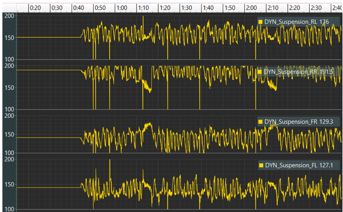
Joonis 20. Vedrustus sensorite mõõtetulemused algse CAN saatmise loogikaga
