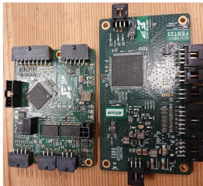
Joonis 27. FEST24 ECU (vasak) ja FEST23 ECU (parem) trükkplaatide võrdlus
