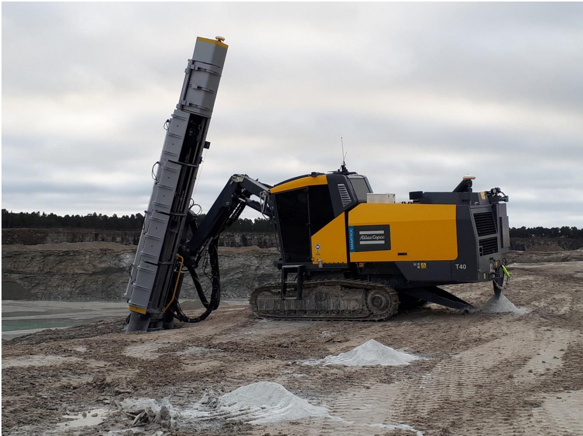
Joonis 15 Puurmasin AtlasCopco SmartROC T40 summuti ja GPS seadmega
