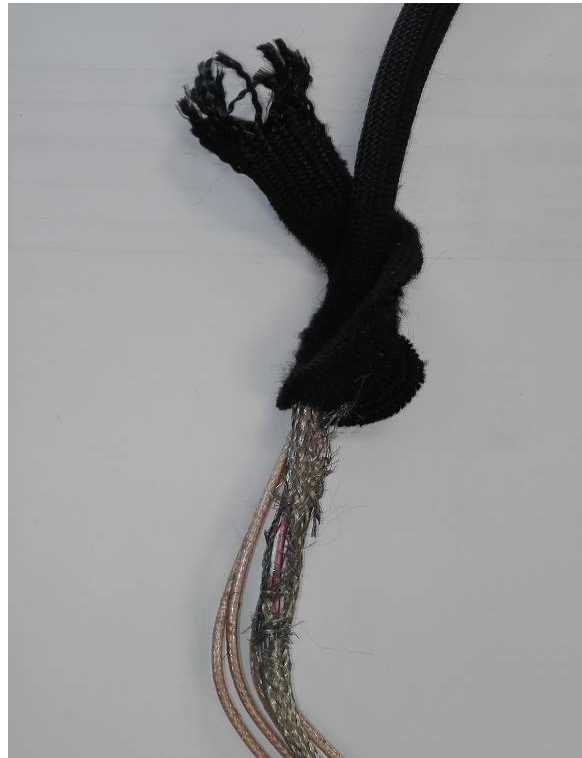
Pilt 9. Riknenud spiraalkaabel pärast nailonsuka eemaldamist. [erakogu]
