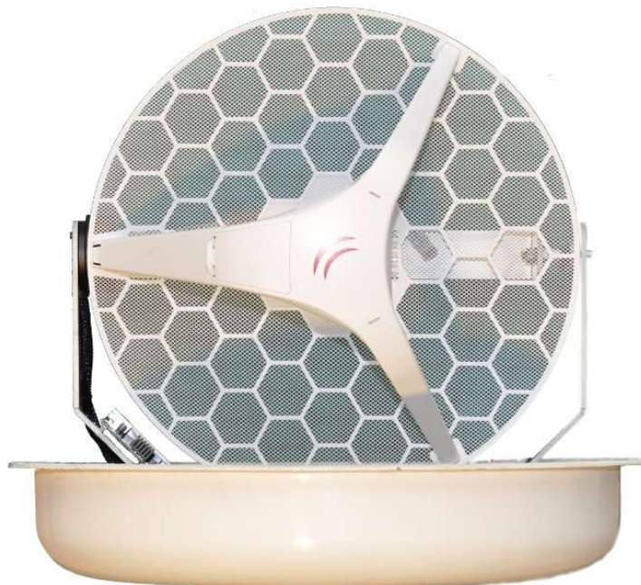
Pilt 12. BLDC mootoritega gürostabiliseeritud platvormi prototüüp
