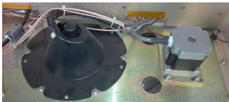
Pilt 6. Kommunikatsioonikaablite spiraal, KVH Trackvision G6. [erakogu]
