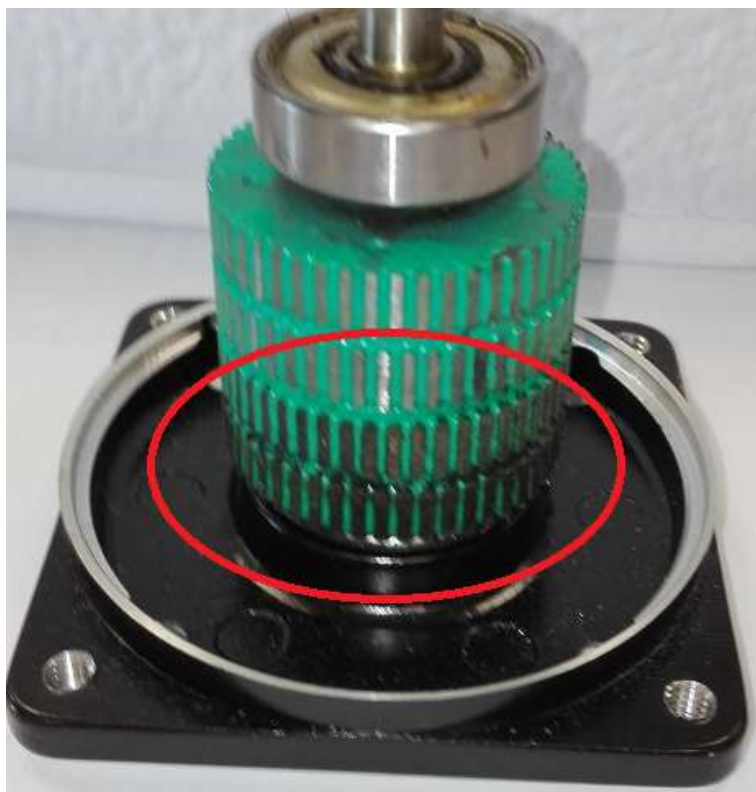
Pilt 8. Laagri riknemisest tingitud kontakt rootori ja staatori vahel Seatel Coastal24 [erakogu]
