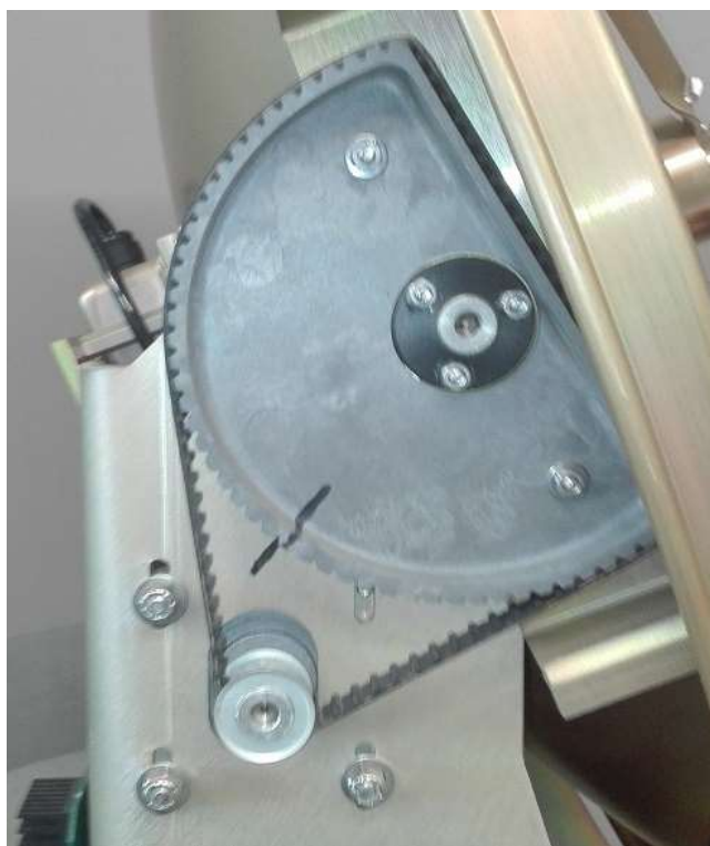
Pilt 4. Tõusunurga ajam, KVH Trackvision G6. [erakogu]
