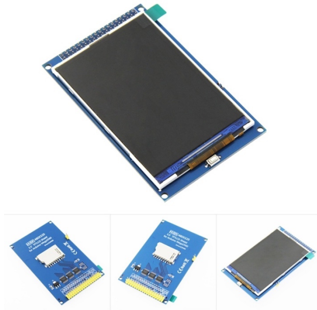
Joonis 2.2 3,5 tolline TFT LCD ekraan [7]
