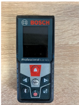
Joonis 3.1 Mõõdistamisel kasutatud laserkaugusmõõtja
