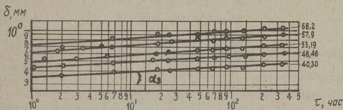
а) Кривые ползучести для прогиба витка пружины на кривых - интенсивность осевой нагрузки q в кГ/мм
