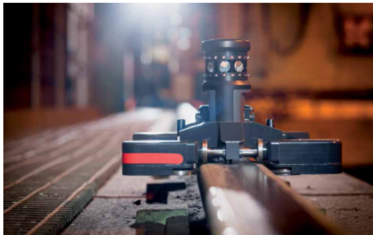
Joonis L1 Firma Conecranes raadio teel juhitav mõõdistusvanker 360° prisma-reflektoriga [1]
