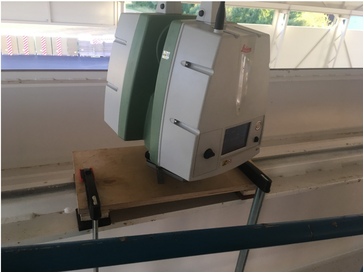
Joonis 5.7 Laserskanner rakisele kinnitatuna
