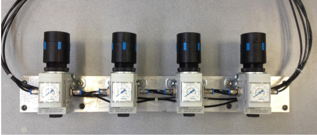
Joonis 19 – Rõhuregulaatorid suunaventiilide ja silindrite vahel
