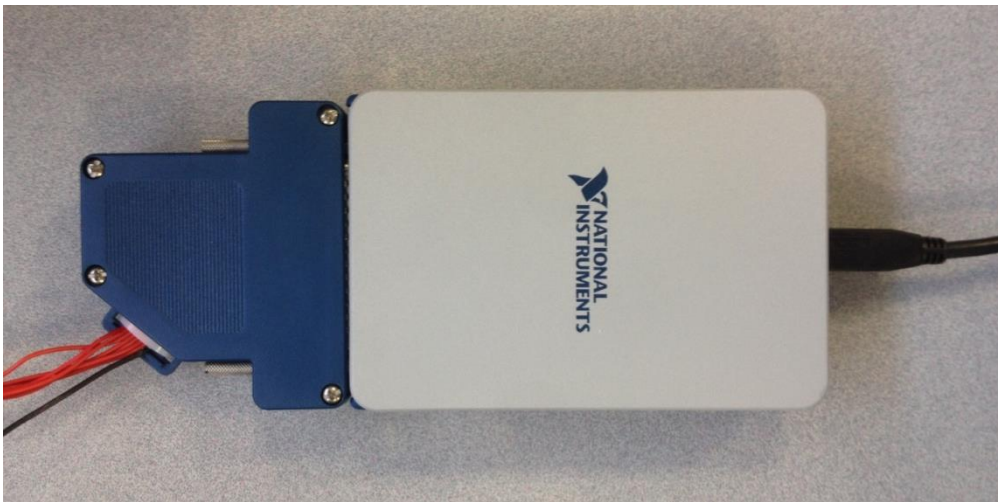
Joonis 12 – NI cDAQ-9171 ühendatud NI 9476 ja NI 9923-ga
