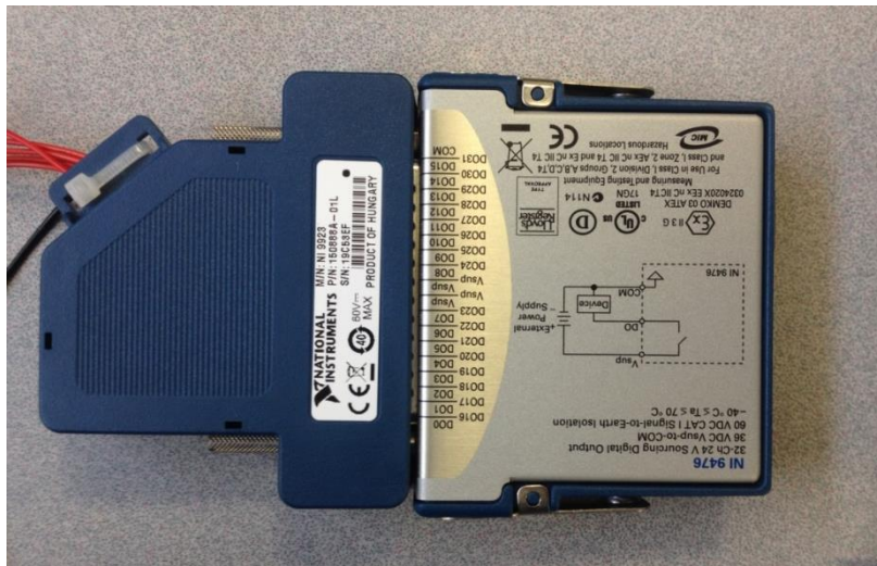
Joonis 14 – NI 9476 ühendatud NI 9923-ga
