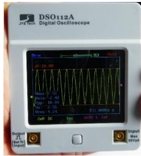
Joonis 1.5. DSO112A puuetundliku ekraaniga ostsiloskoop.
