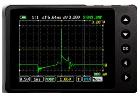
Joonis 1.3. uScope kaasaskantav ostsilloskoop. [7]
