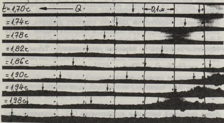
Рис. 2. Кинограмма процесса турбулизации в трубе. Стрелками указано возникновение вихревых структур и их перемещение по направлению течения.
