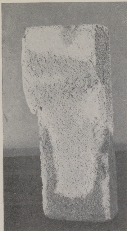
Joon. 7. Kapillaarselt immutatud gaasbetoonkivi. Gaasbetoonkivide puhul tuleb oletada, et pooride seinte märgumise tõttu osa sisemisi poore jääb õhuga täidetuks.
