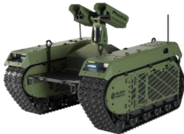
Joonis 3. THeMIS mehitamata maismaasõiduk, millele on kinnitatud Marduk Shark. [49]
