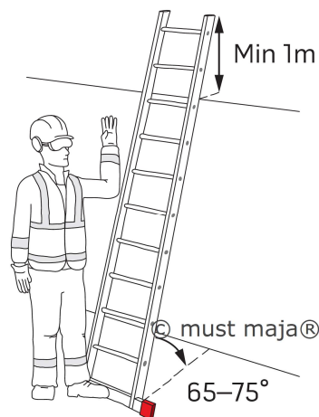
Joonis 3.6 Lubatud üksikredeli näide (allikas: Must Maja Kaardipakk)
