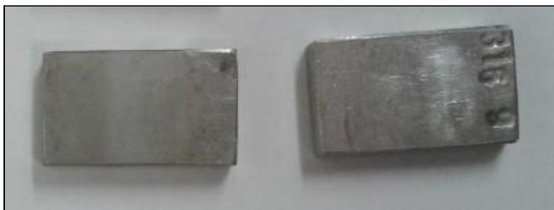
Рис. 4.1.1.1. Тестовые образцы нержавеющей стали AISI 316
