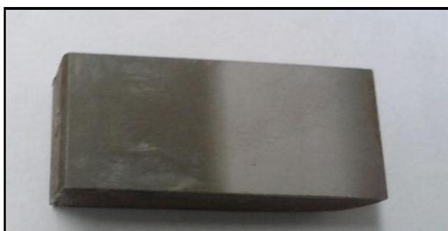
Рис. 4.1.2.1. Тестовый образец металлокерамики  $\text{Cr}_2\text{C}_3 - \text{NiCr}$
