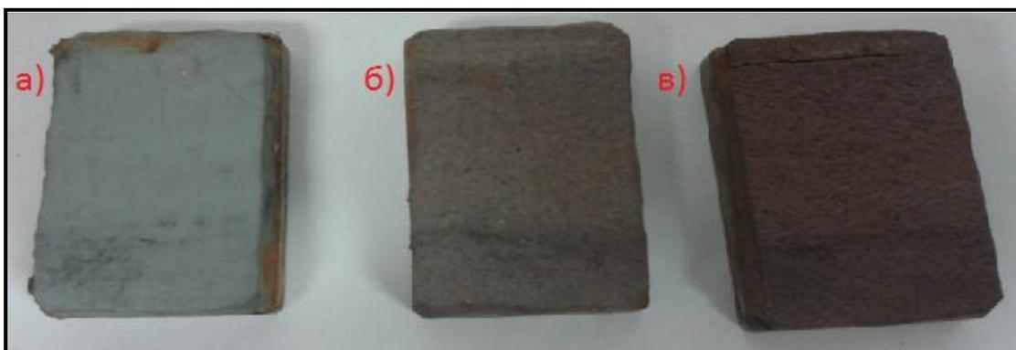
Рис. 4.1.7.1. Тестовые образцы: а) «Kiiltofix» 100%; б) «Kiiltofix» 80% базальт 20%; в) «Kiiltofix» 60% базальт 40%
