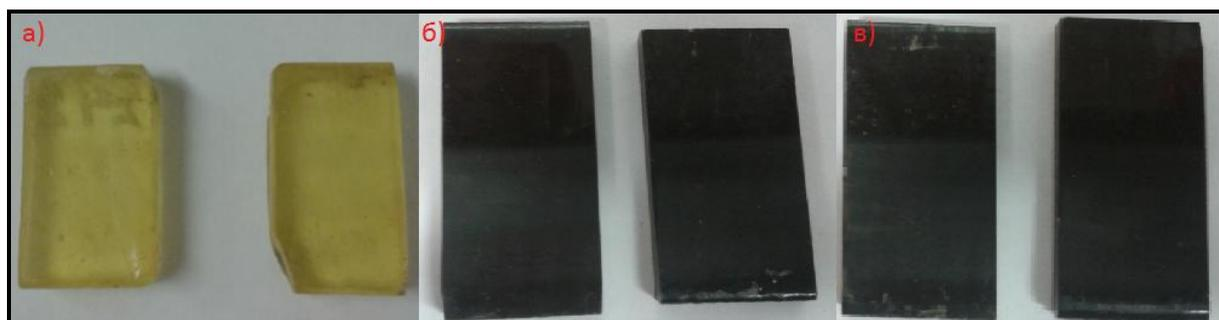
Рис. 4.1.6.1. Тестовые образцы: а) эпоксид 100%; б) эпоксид 80% базальт 20%; в) эпоксид 60% базальт 40%
