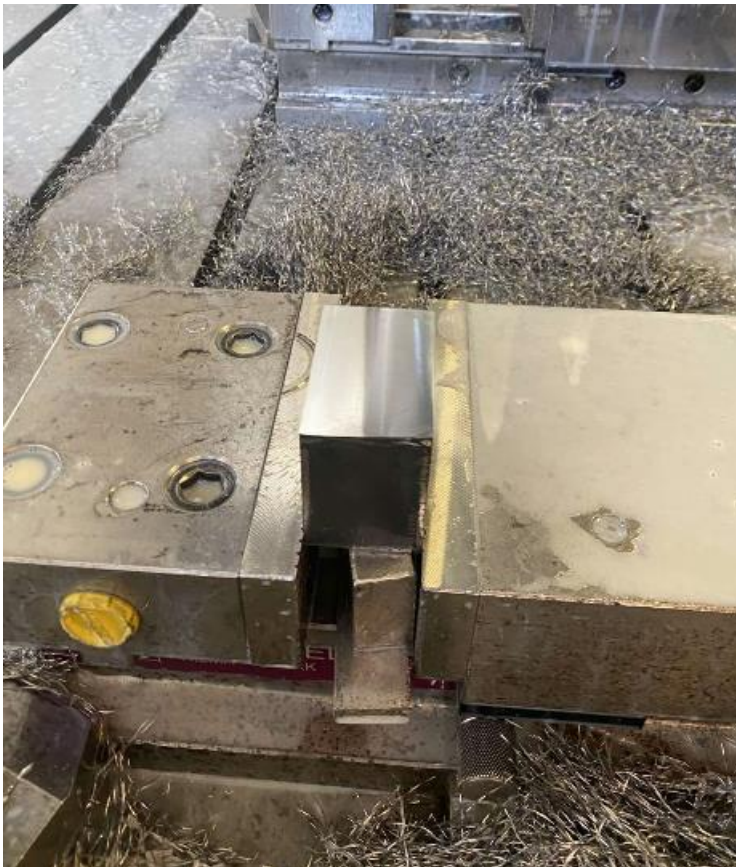
Joonis 3.3.3 Valminud detail, mis on loodud makroprogrammi abil.
