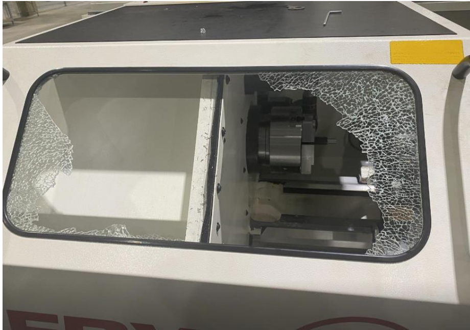
Joonis 1.1.2 Seadme kahjustamine programmi kirjutamise vea tõttu
