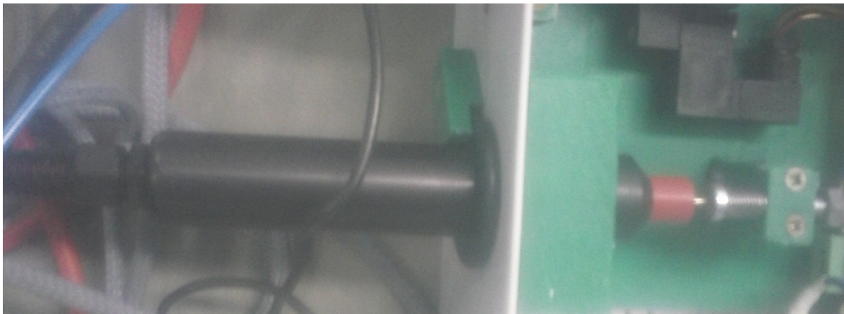
Sele 7.12. Rakise ühendamine kõrgepinge otsikuga.
