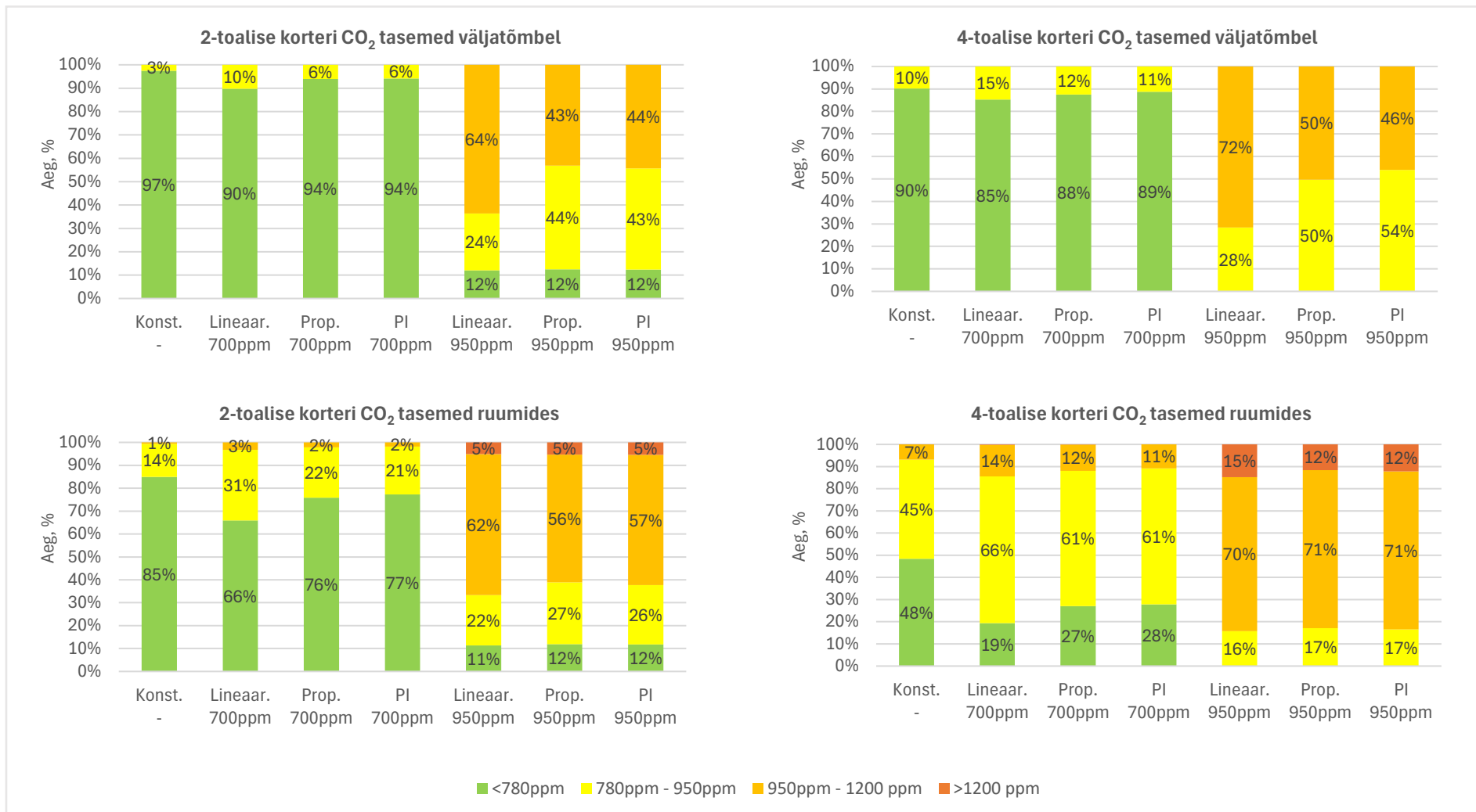
Joonis 4.7 Korterite ventilatsioonüsteemi juhtimisloogikate võrdlus
