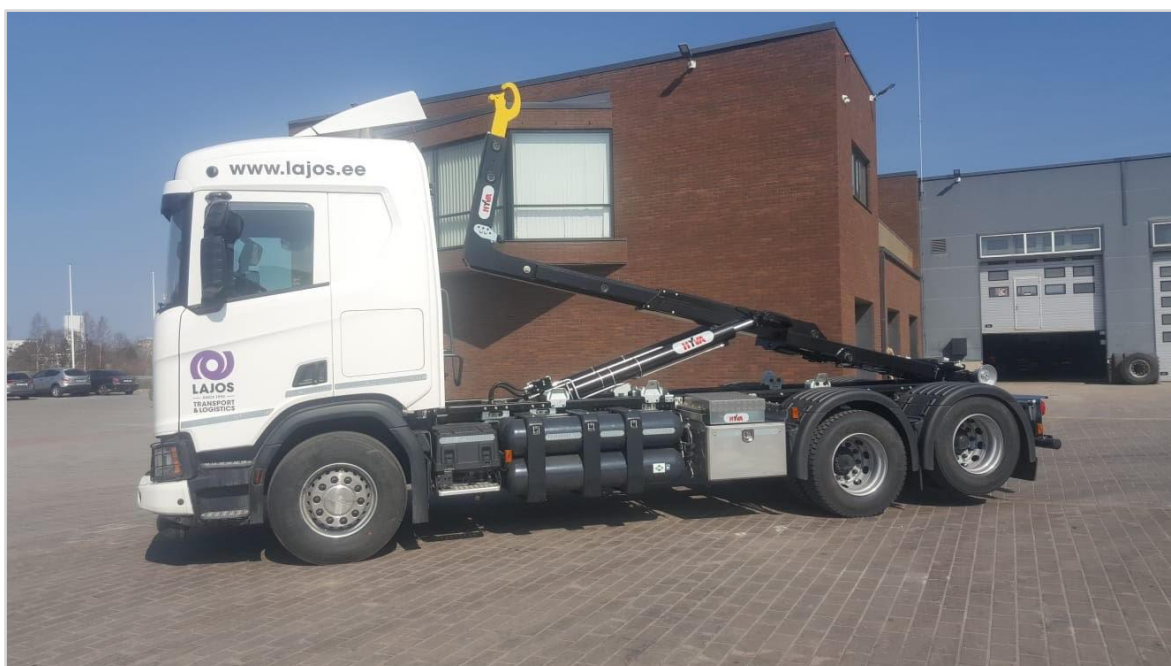
Joonis 2.4 Lajos AS surugaasil põhinev konkslift raskeveok Allikas: autori poolt koostatud
