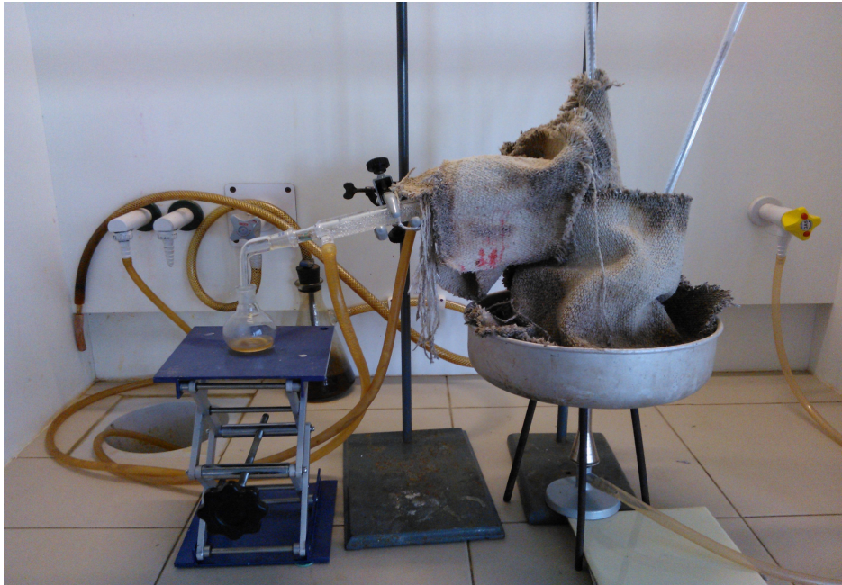
Joonis 4.5. Utmine klaaskolvis samaaegsete gaaside kogumisega
