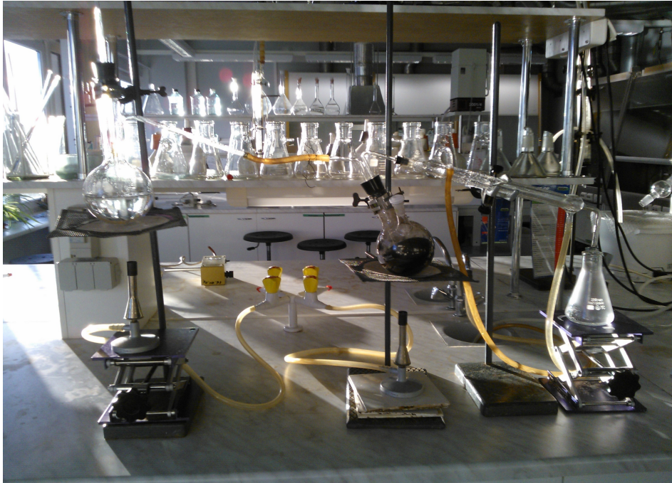
Joonis 4.4. Utmiskatse kolvijäägi veeaurdestillatsioon
