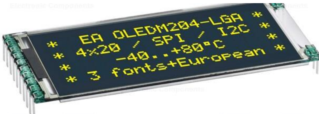
Joonis 5.2 Näide OLED SPI-liidesega vedelkristallkuvarist (allikas: tme.eu)
