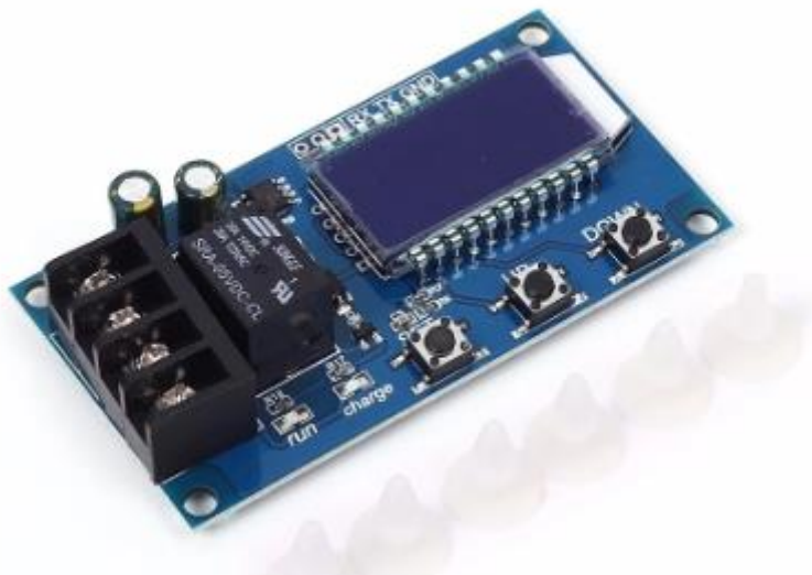
Joonis 1.6 XY-CD60L akulaadija kontrolleri moodul [11]
