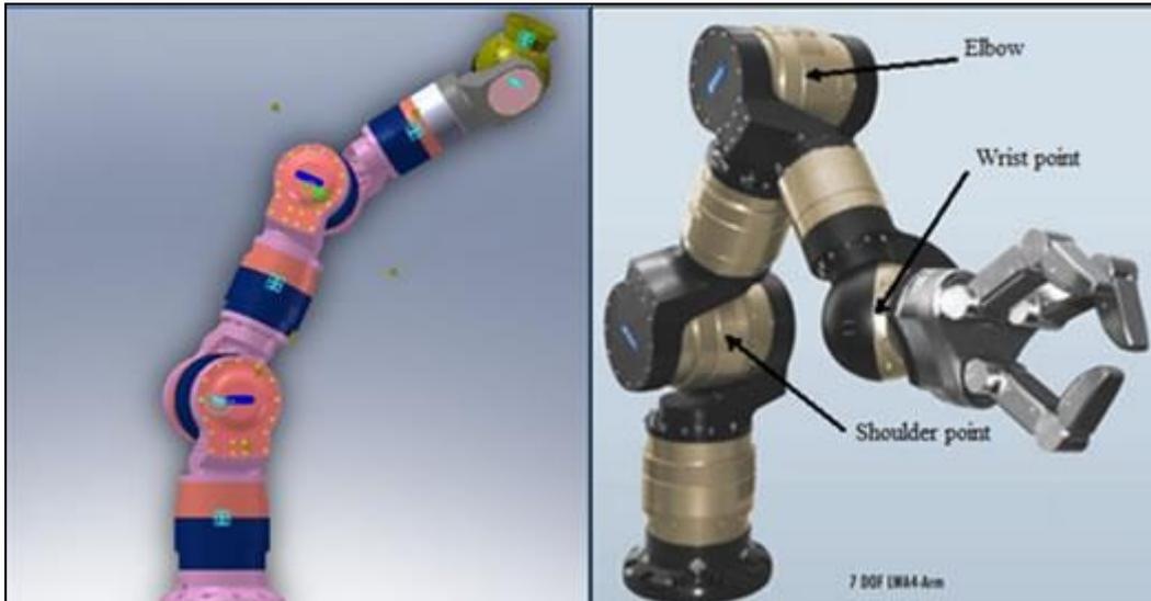
**Figure 8.** Redundant robot
