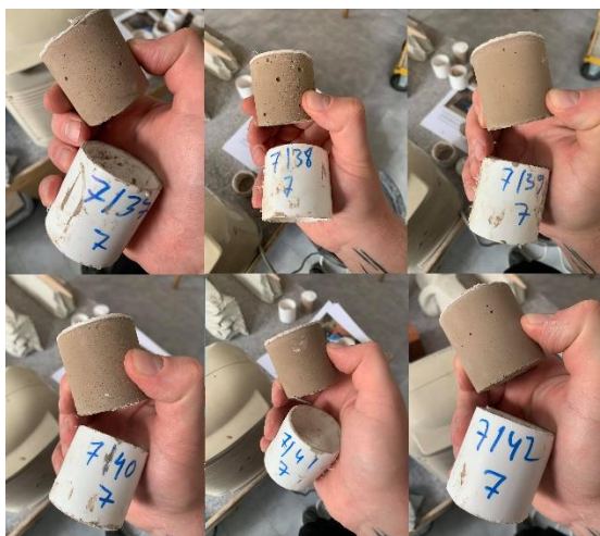
Joonis 4.32 Seitsmenda etapi 7 päevased katsekehad, autor Marko Ehrlich
