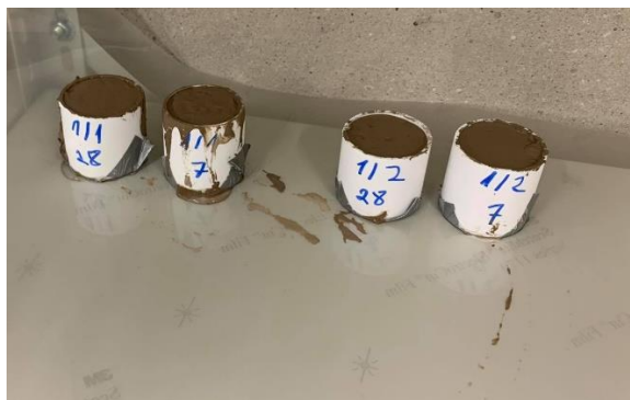
Joonis 4.1 Katsekehad numbriga 1 ja 2 peale tihendamist, autor Marko Ehrlich
