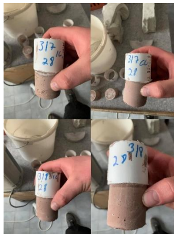
Joonis 4.11 Kolmanda etapi 28 päevased katsekehad, autor Marko Ehrlich
