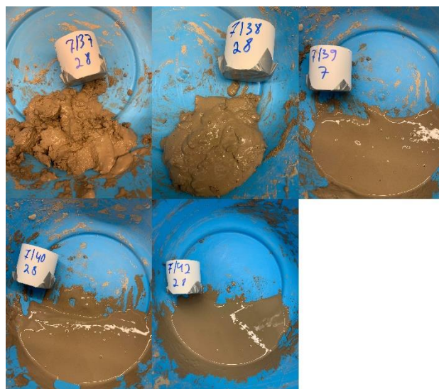
Joonis 4.30 Seitsmenda etapi katsekehade segud, autor Marko Ehrlich
