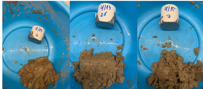
Joonis 4.13 Väiksema molaarsusega katsekehade segud, autor Marko Ehrlich
