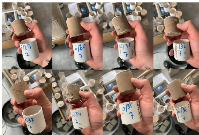
Joonis 4.27 Kuuenda etapi 7 päevased katsekehad, autor Marko Ehrlich
