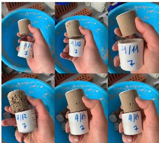
Joonis 4.16 Neljanda etapi 7 päevased katsekehad, autor Marko Ehrlich
