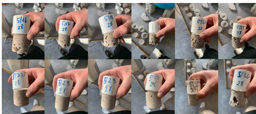
Joonis 4.23 Viienda etapi 28. päevased katsekehad peale kuivamist, autor Marko Ehrlich
