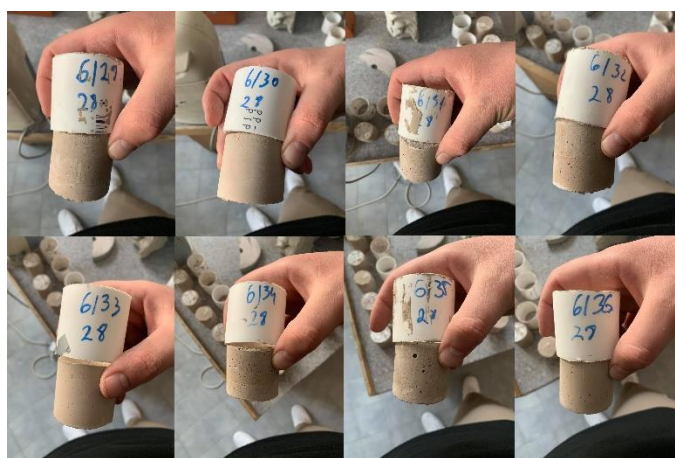
Joonis 4.29 Kuuenda etapi 28 päevased katsekehad, autor Marko Ehrlich
