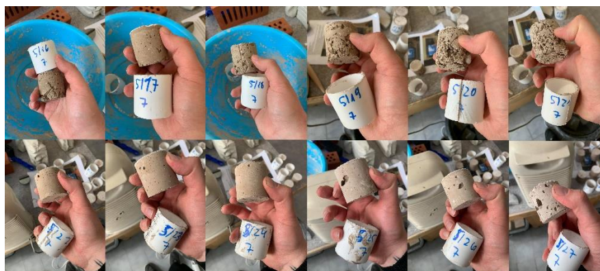
Joonis 4.21 Viienda etapi 7. päevased katsekehad peale kuivamist, autor Marko Ehrlich
