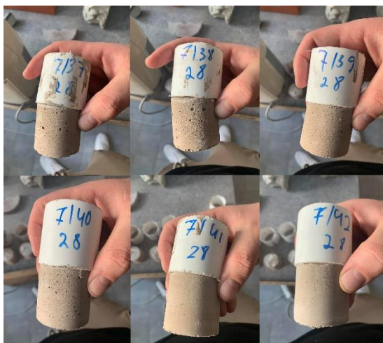
Joonis 4.34 Seitsmenda etapi 28 päevased katsekehad, autor Marko Ehrlich
