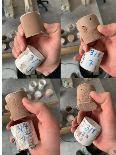
Joonis 4.9 Kolmanda etapi 7 päevased katsekehad, autor Marko Ehrlich
