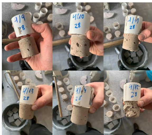
Joonis 4.18 Neljanda etapi 28 päevased katsekehad, autor Marko Ehrlich
