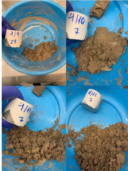
Joonis 4.12 Väiksema vedeliku sisaldusega katsekehade segud, autor Marko Ehrlich
