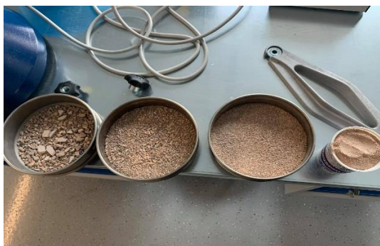
Joonis 4.24 Purustatud ja sõelutud keraamiline jääde, autor Marko Ehrlich
