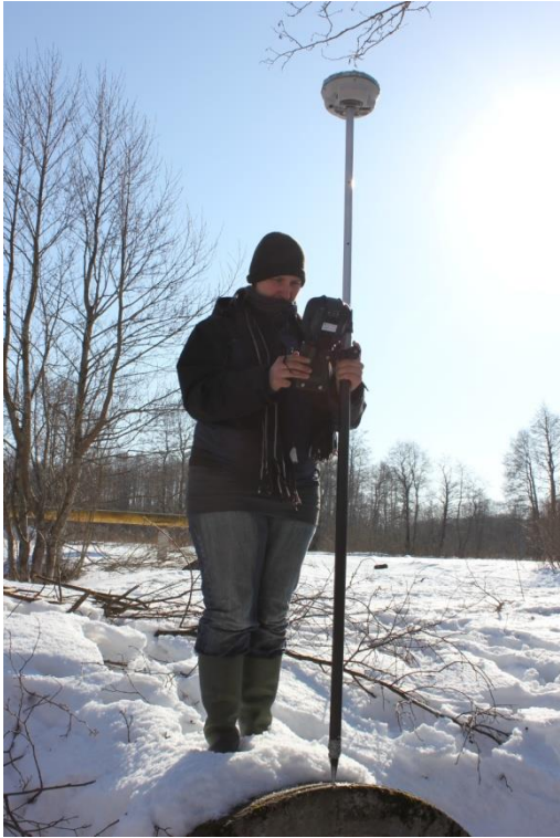
Joonis 33 Mõõtmispunktide reeperite abs.kõrguste mõõdistamine reaalaaja gps-ga [8, 13]
