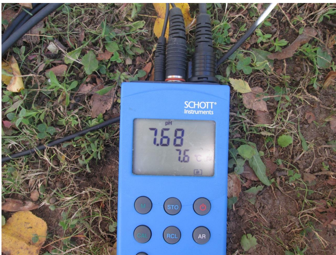
Joonis 37 Elektrijuhtivuse ja pH mõõtmine
