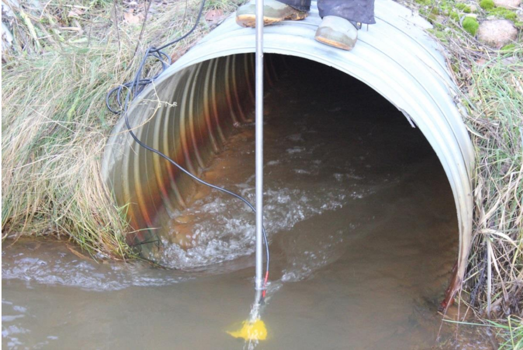
Joonis 35 Vooluhulga mõõtmine mõõtmispunktis 3
