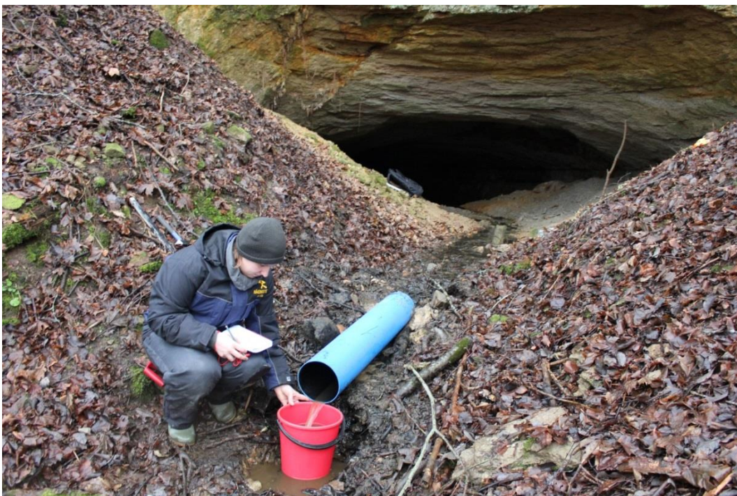
Joonis 36 Vooluhulga mõõtmine mõõtmispunktis 7 mahumeetodil [13]
