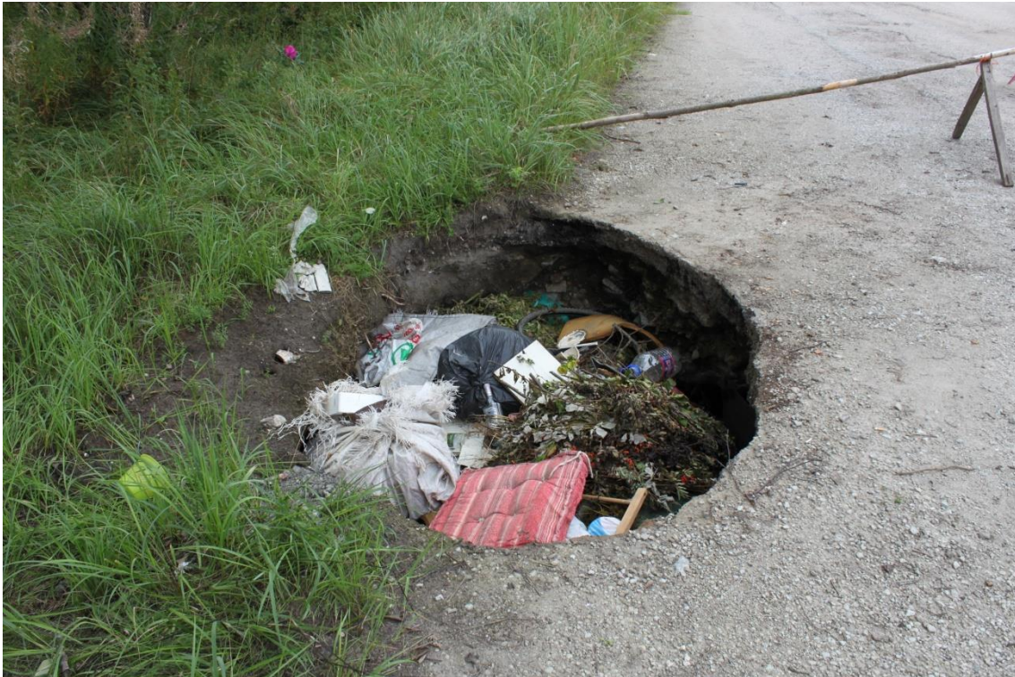
Joonis 4 Varing Maardu kaevanduse alal, mis on täidetud prügiga [13]
