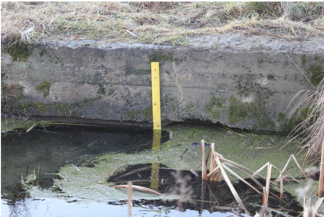
Joonis 34 Paigaldatud reeper mõõtmispunktis nr. 2
