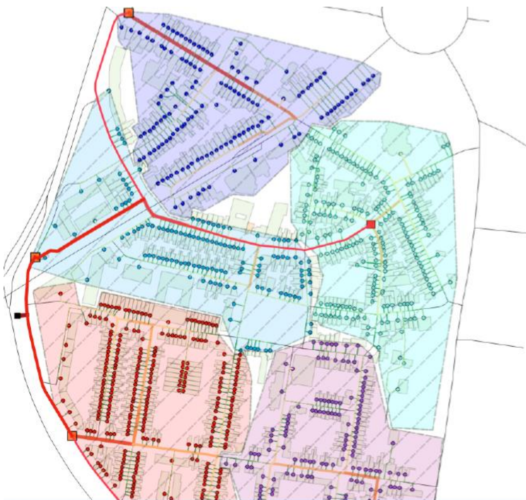
Joonis 5.3. Rakendusega Comsof Heat loodud kaugküttevõrgu plaan
