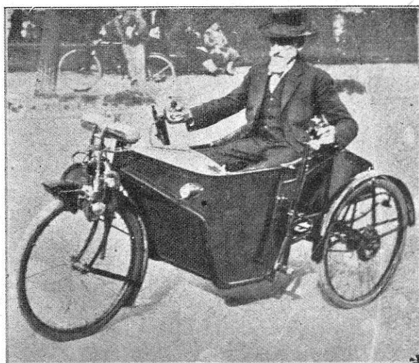
Iseõitev vanker haigete jaoks. Carl Oplatek'i leidus. Leidur on näha pildil demonstreerimas oma leidust. Vankri mootor ja bensiinipaak asuvad ederatal. Mootor on kahetaktiline 72 ccm.
