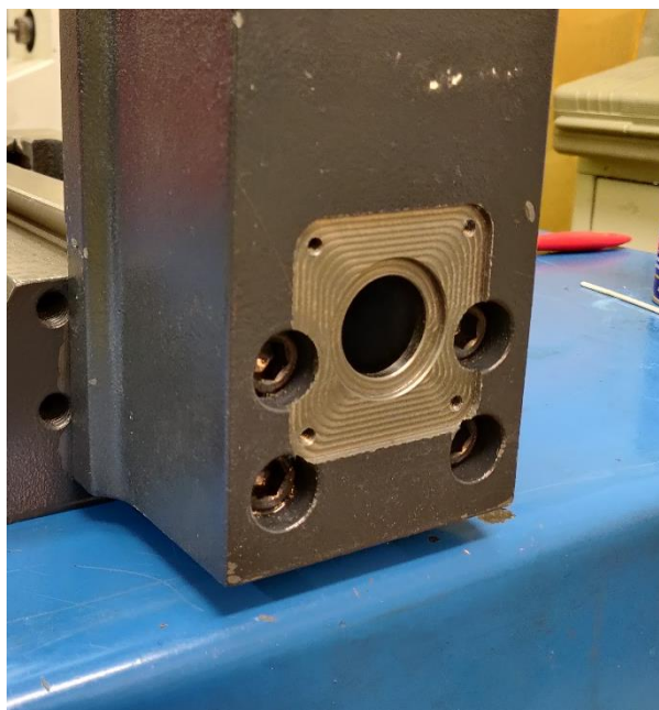
Joonis 2.4 Mootorite kinnitusdetailid. Vasakul X-telje mootorikinnitused koos töölaua otsaga, paremal Z-telje distants mootorikinnitused
