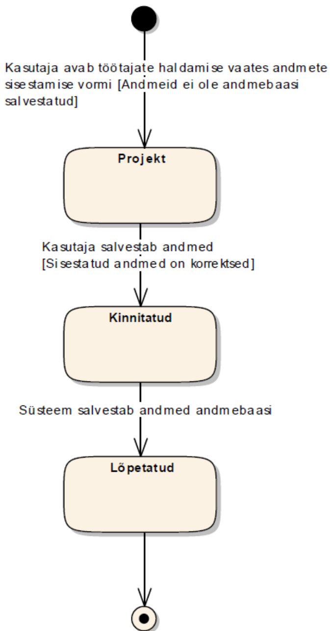
Joonis 57 Loomeliidu töötaja sisestuse seisundidiagramm
