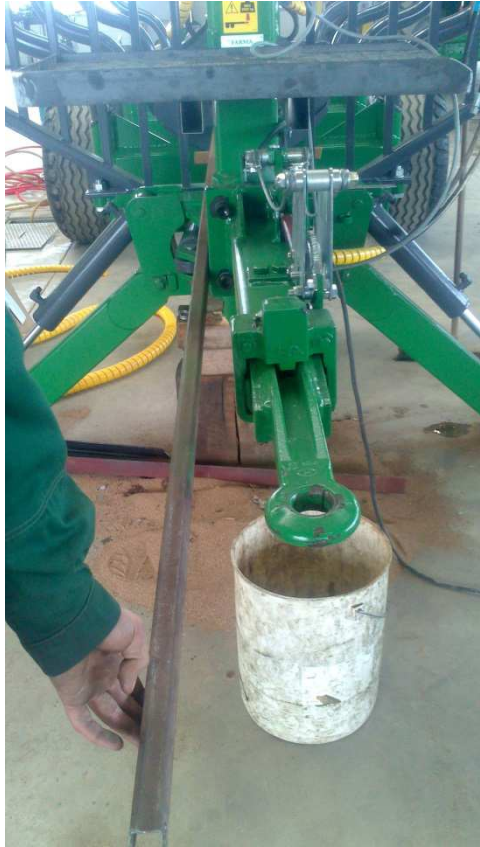
Sele 7.1. T7-T8 veotiisli deformatsioon
