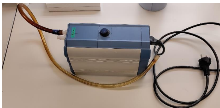
Joonis 2.5 Reaktorist segu välja võtmisel ja filtreerimisel kasutatud vaakumpump (autori foto)
