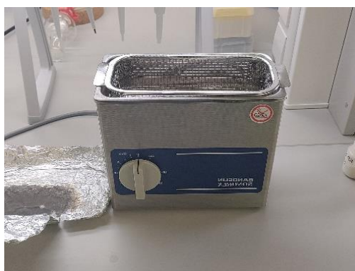
Joonis 2.2 Ultraheli vann lähteainete lahustamiseks vesilahuses (autori foto)
