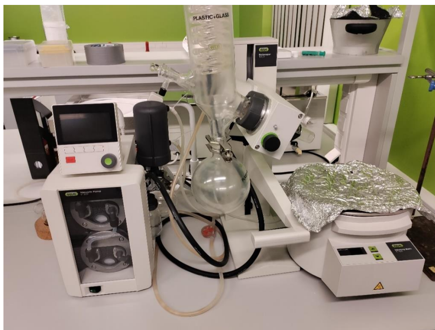
Joonis 2.6 Filtreeritud produktist vee eemaldamiseks kasutatud pöördaurusti (autori foto)
