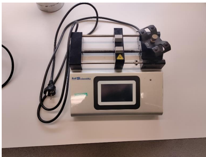
Joonis 2.3 Reaktorist saadud segu hapestamiseks kasutatav laboratoorne süstlapump (autori foto)
