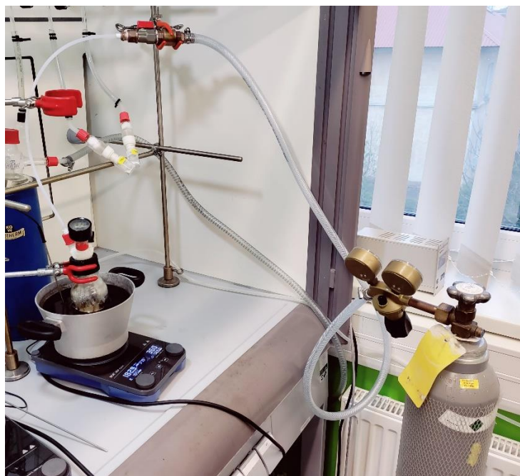
Joonis 2.12 Dikarboksüülhappe süntees pudelis, mis asub õlivannis ning on CO 2 rõhu all (autori foto)
