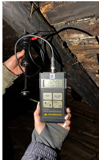
Joonis 2.34 Põlenud sarika niiskuse sisalduse mõõtmine (autori foto, mai 2020)
