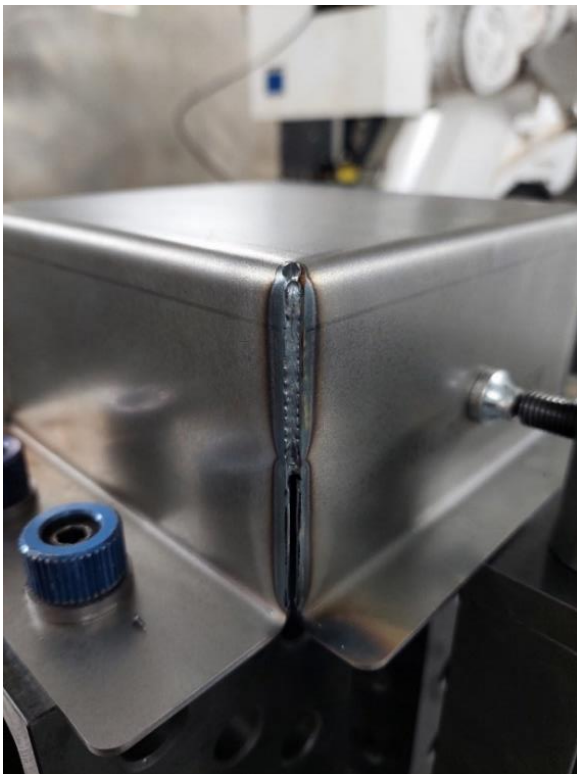
Joonis 50. Ebaõnnestunud traadiga keevitus, P=3000 \text{ W}
