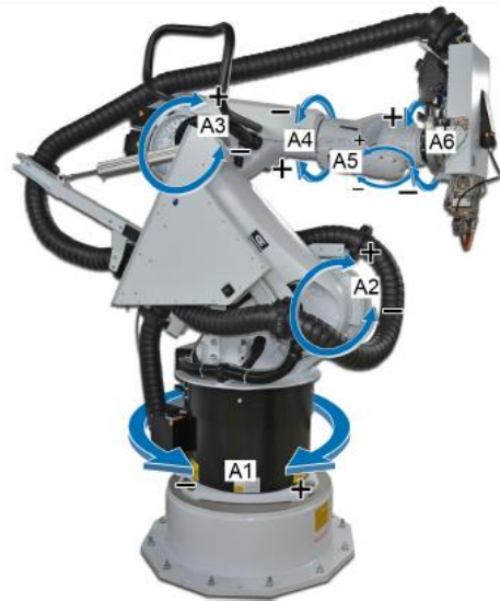
Joonis 43. KUKA 6-teljeline tööstusrobot KR-30 HA, 30 tähendab nimetuses tema tööriista kandevõimet, keevitamise puhul on see vähe tähtis, mis laserkeevituse jaoks sobib.
