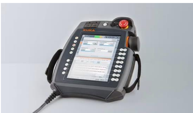
Joonis 17. Õpetamiseade (smartPAD) millega saab keerulisi programme lihtsalt õpetada ja roboti liikumisi muuta. KUKA SmartPAD. [11]
