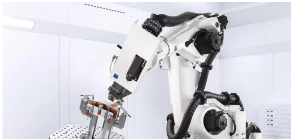
Joonis 43. KUKA 6-teljeline tööstusrobot KR-30 HA, 30 tähendab nimetuses tema tööriista kandevõimet, keevitamise puhul on see vähe tähtis, mis laserkeevituse jaoks sobib.
